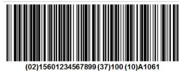
Figura 2.3: Exemplo de um código de barras GS1-128.
