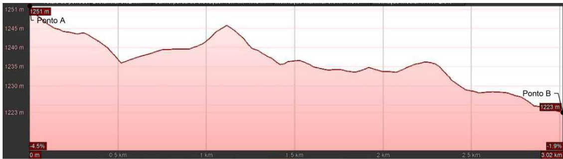
Figura 13: Perfil longitudinal da EBVT. (Freitas, 2019).
