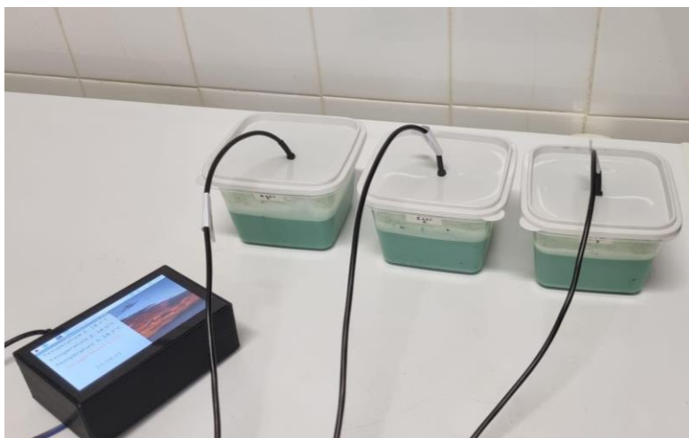
Figura 2 - Sensores de temperatura colocados nos gelados com 25% de biomassa.
