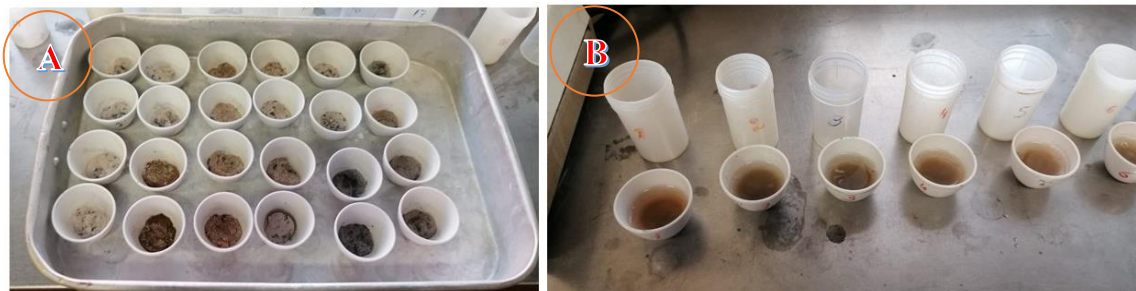
Figura 7: Procedimento de determinação do boro por incineração (A) e coloração com azometina-H (B).
