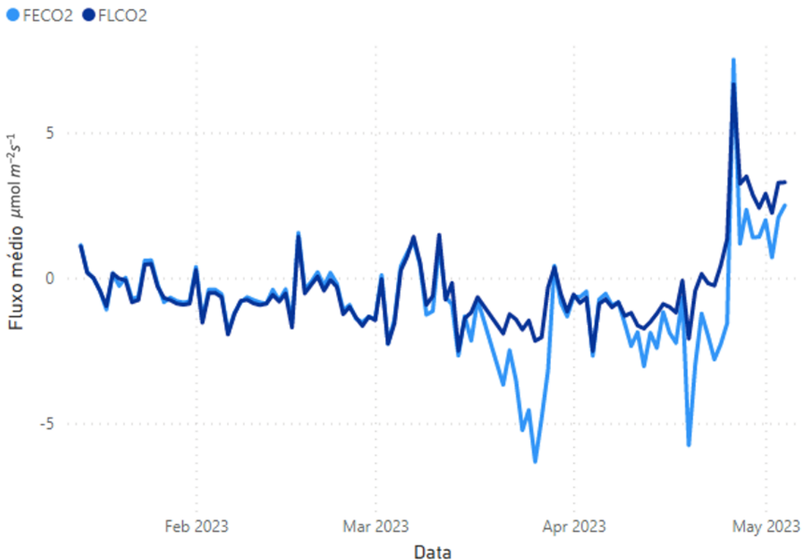
Figura 4.13: Evolução temporal dos valores médios de fluxos de CO_2 ao longo do período de avaliação, obtidos pelo método de regressão linear e regressão exponencial.
