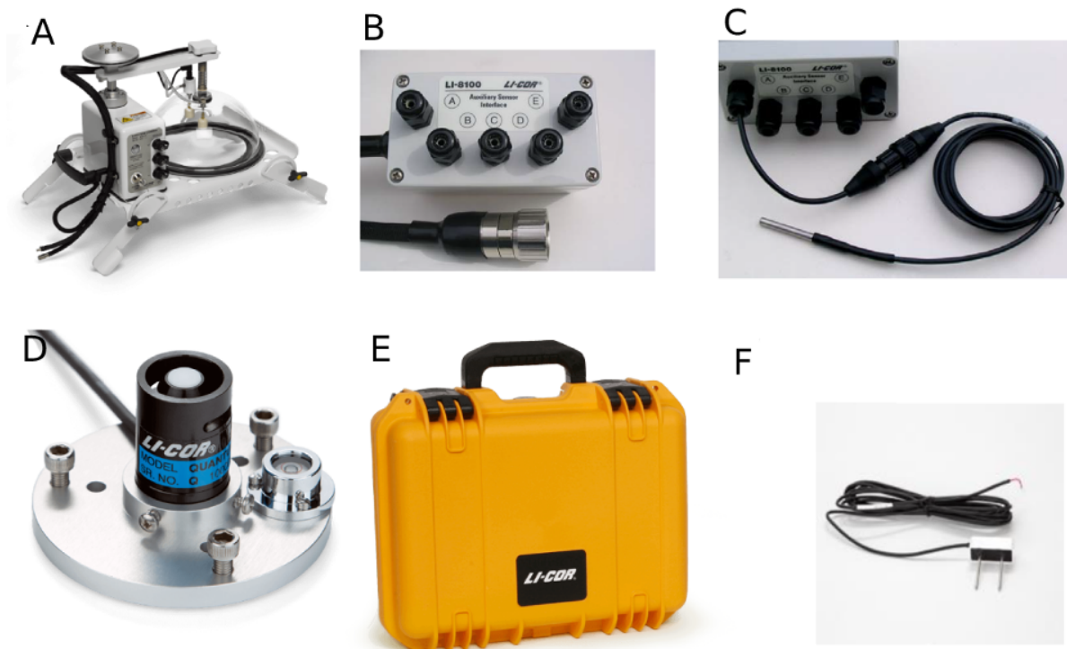
Figura 3.3: módulos e sensores do analisador de gás da LI-COR Biosciences (modelo LI-8100A) [81]
