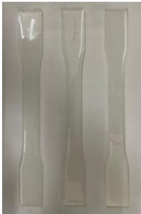
Figura 3.9 - Corpo de prova de resina epóxi curada com presença de bolhas de ar
