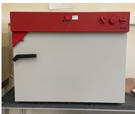
Figura 3.7 - Forno de secagem utilizado para cura dos corpos de prova
