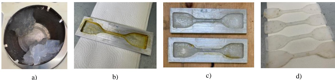
Figura 3.8 - Etapas do processo de fabricação dos corpos de prova: a) mistura; b) camada de cera de abelha como desmoldante; c) preenchimento do molde com o silicone; d) corpos de prova após cura e desmoldagem
