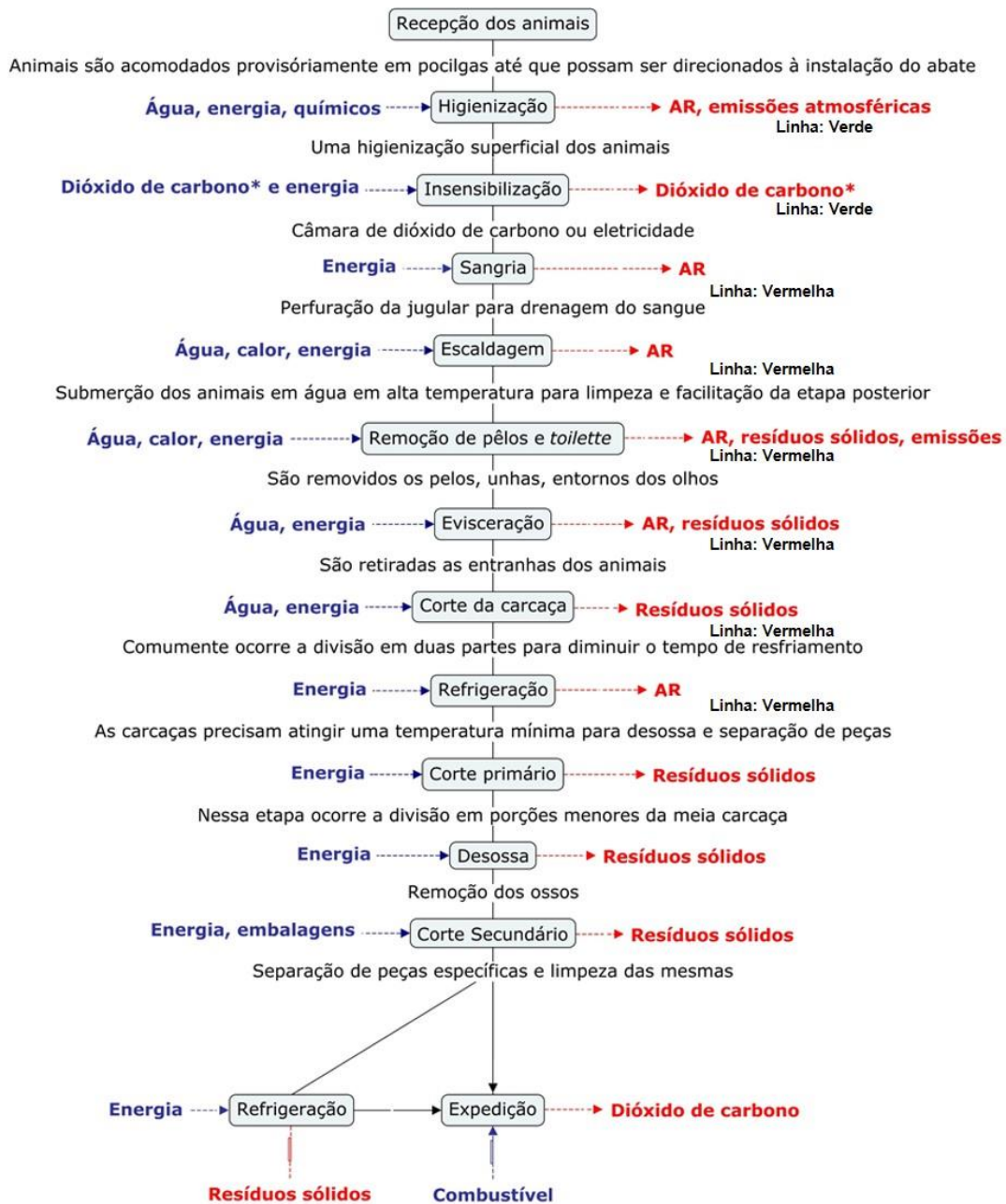
Figura 6. Fluxograma genérico de abate de suínos. Fonte: adaptado European Commission, 2005
