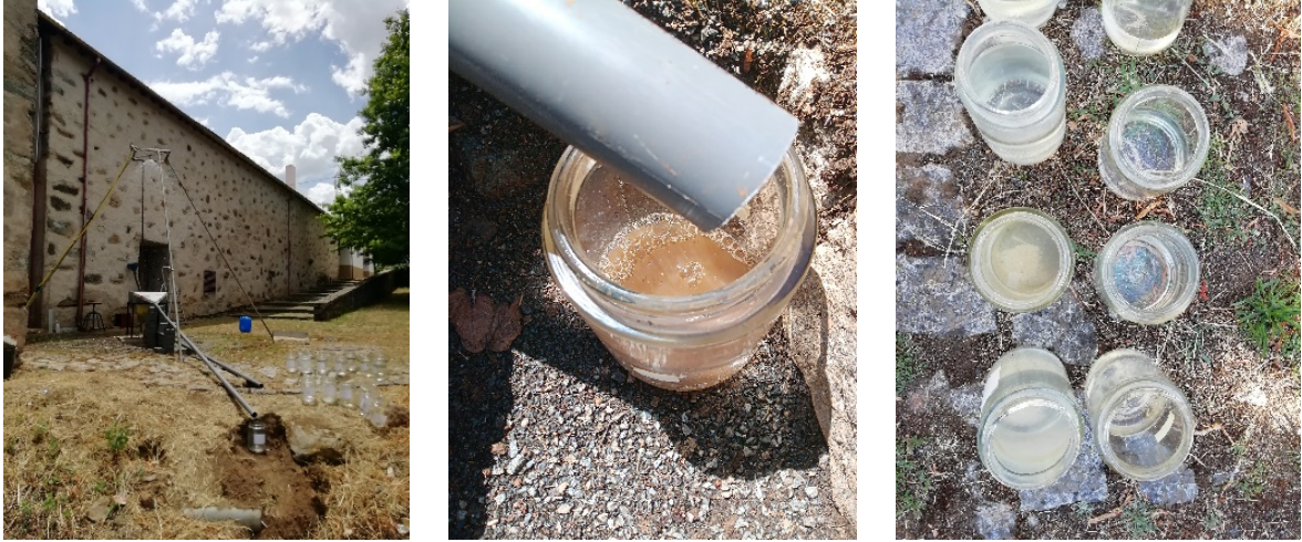
Fig. 59 - Recogida de aguas de infiltración y de escorrentía
