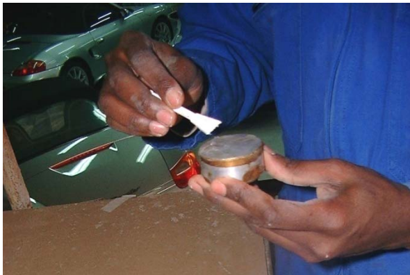
c) Aplicação da resina sobre a pastilha metálica.
