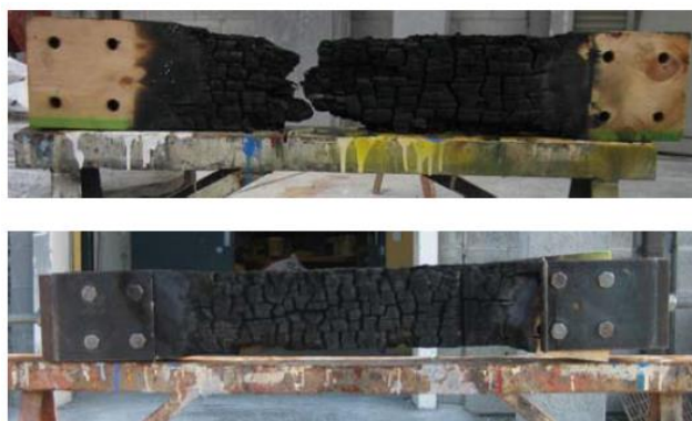
Figura 1 - Rotura após teste ao fogo [11]
