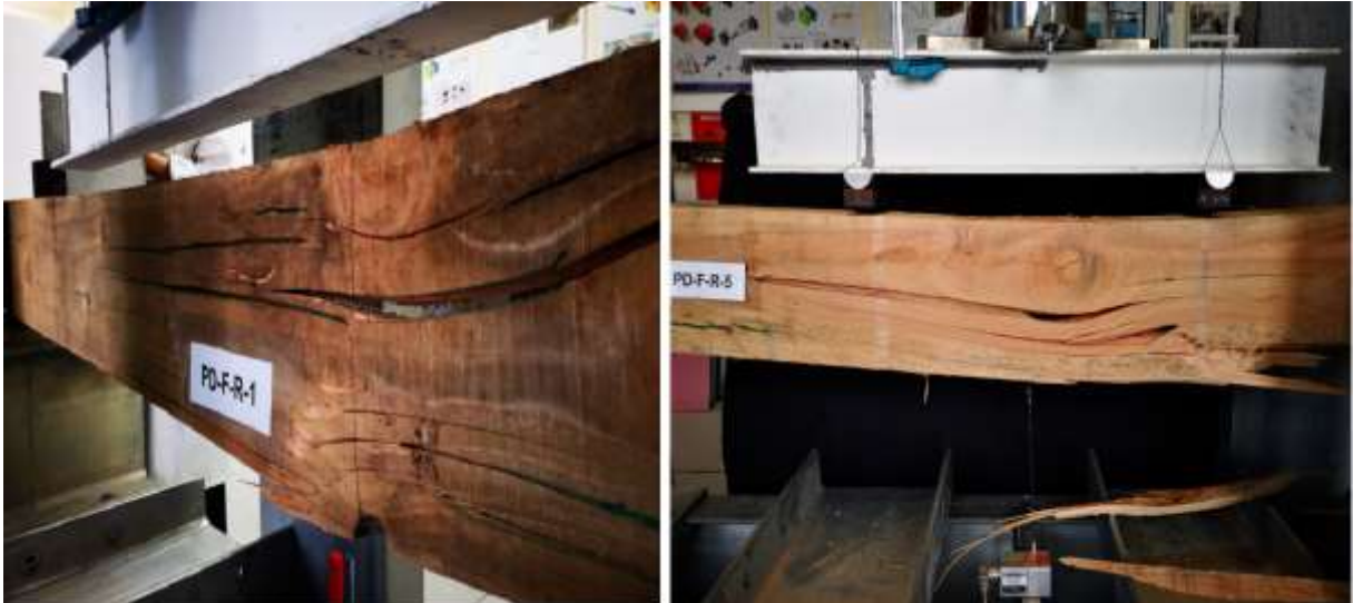
Figura 64 – Ruptura das amostras em escala real.
