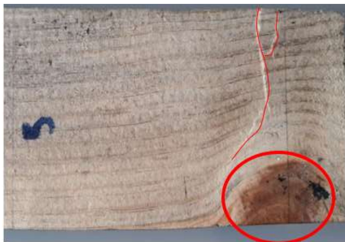
Figura 59 – Ruptura do provete PD-IC-186-5.
