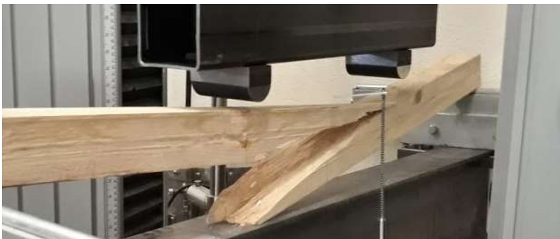
Figura 52 – Ruptura brusca por corte.
