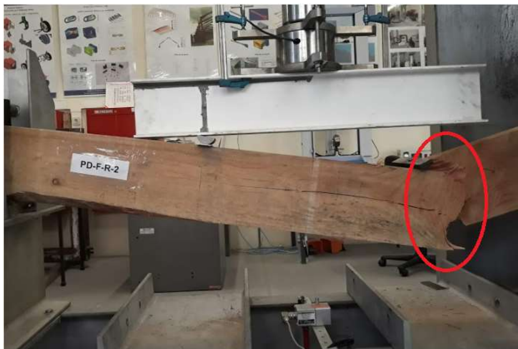
Figura 65 – Corte brusco ocorrido em uma das amostras.
