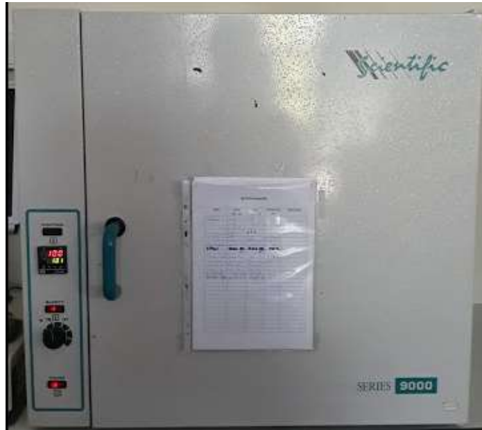
Figura 45 – Estufa utilizada na secagem da madeira.
