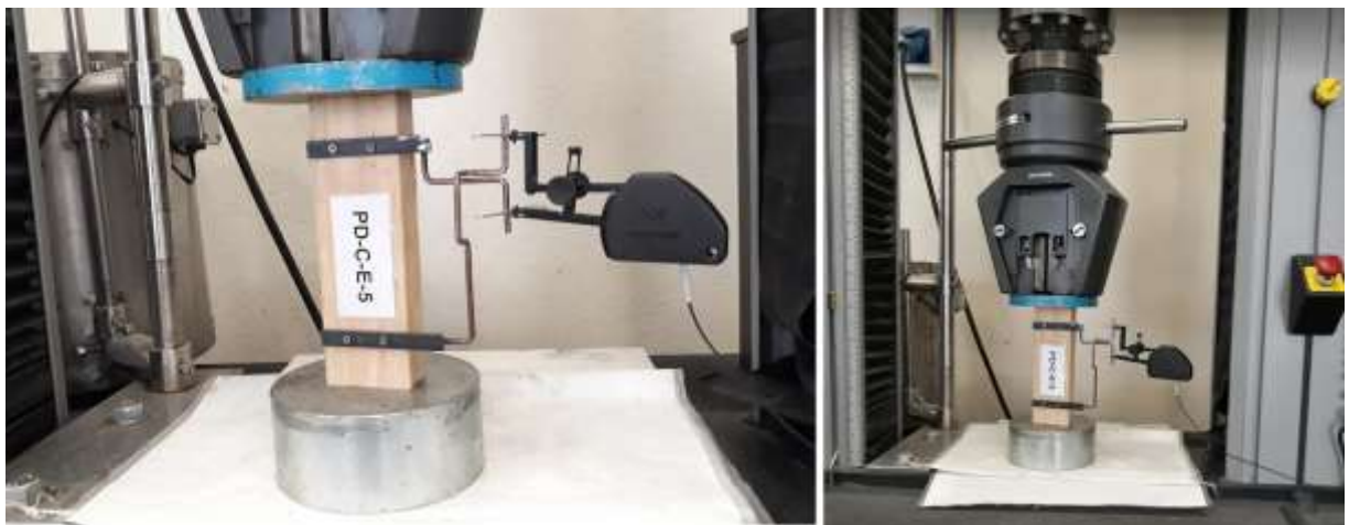
Figura 40 – Amostras ensaiadas com o extensômetro eletromecânico.
