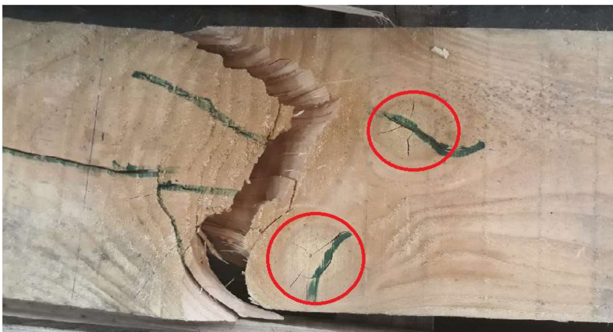
Figura 66 – Rompimento da amostra PD-F-R-5.
