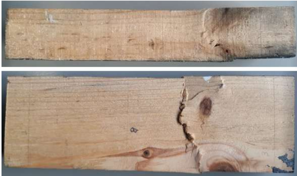
Figura 56 – Ruptura próximas aos nós.
