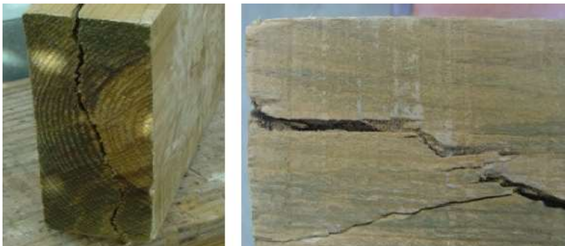
Figura 17 – Peça de madeira com fendas com grande profundidade, [2].
