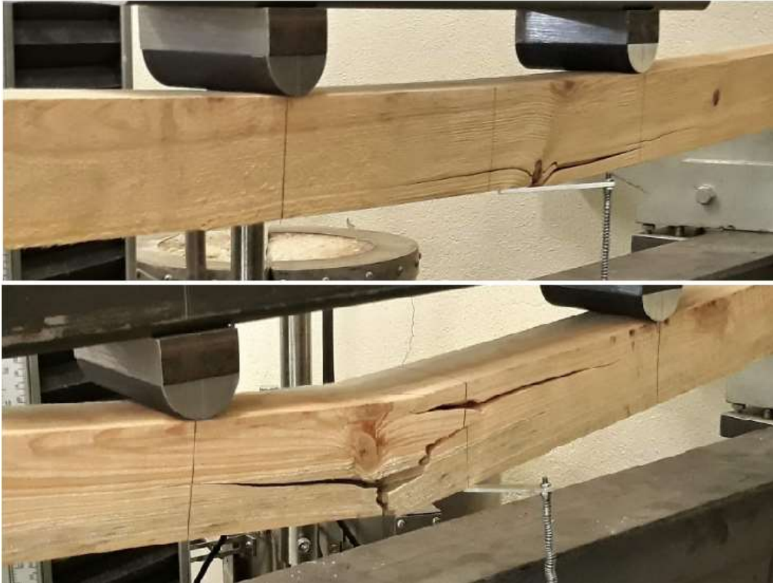
Figura 51 – Ruptura ao longo do comprimento e rompimento por tração.
