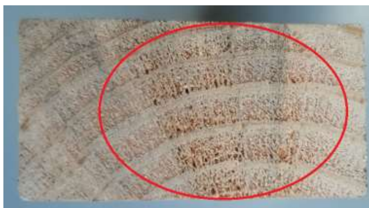
Figura 62 – Porosidade contida na amostra PD-EM-200-5.
