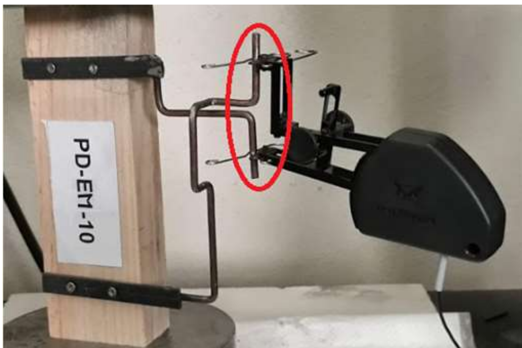
Figura 61 – Distorção no dispositivo fixado ao provete e atrelado ao extensômetro.
