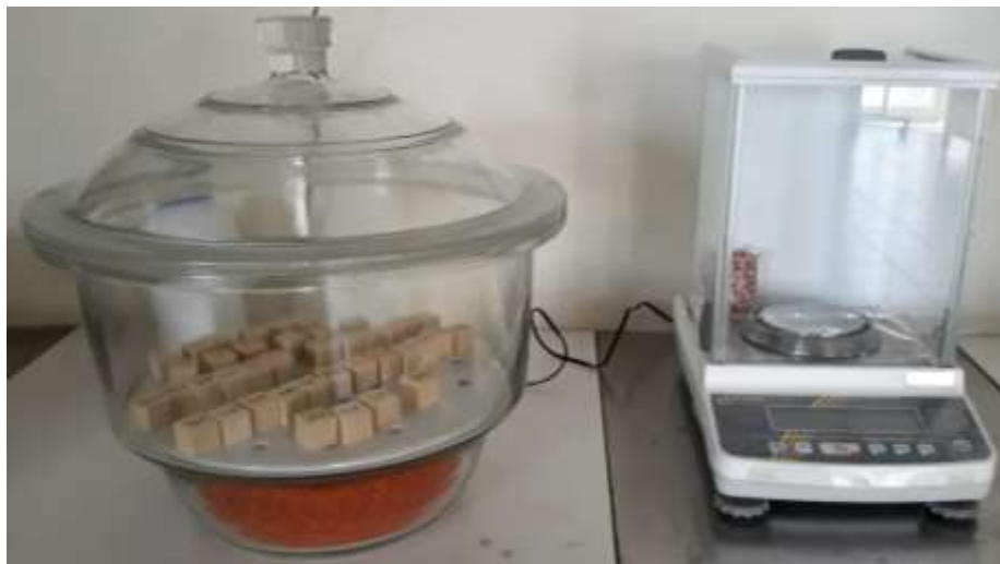
Figura 46 – Dessecador e balança utilizada para a pesagem.
