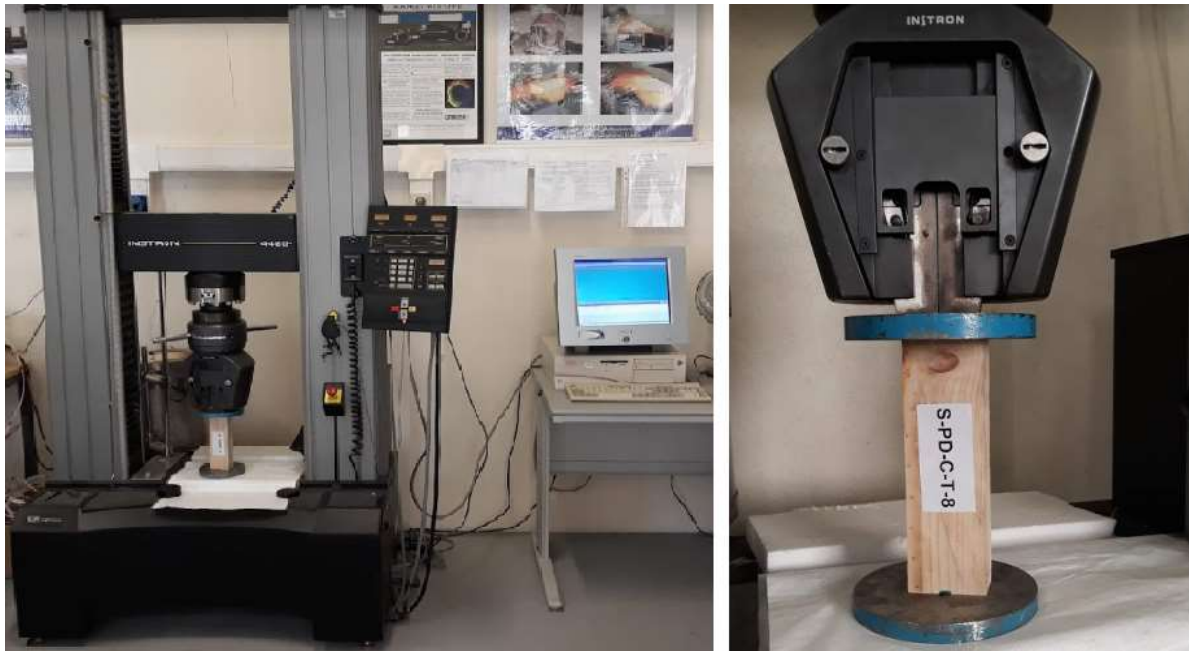
Figura 34 - Layout dos ensaios de compressão axial.
