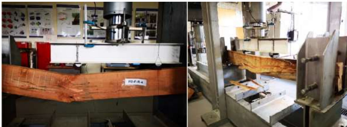
Figura 50 - Amostras sujeitas ao ensaio de flexão.
