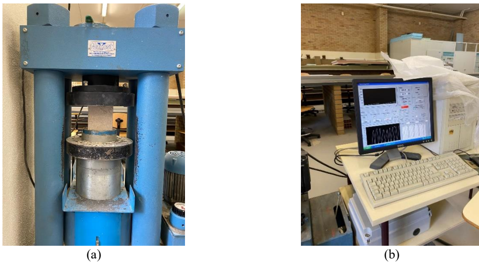
Figura 6 - Resistência a compressão. (a) Ensaio na prensa; (b) Comando da prensa.
