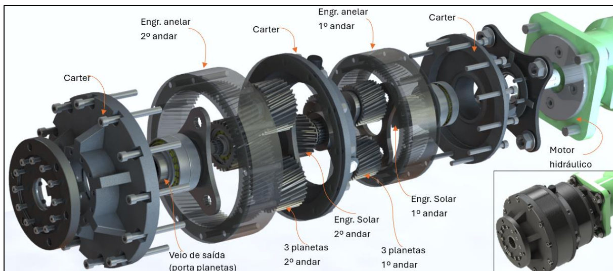
Figura 22 - Vista explodida da redutora planetária (fonte: Modelo 3D - SolidWorks Render)
