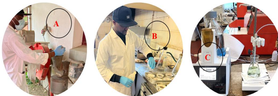
Figura 8 – Processamento e análise bromatológica das amostras de ração: (A) Trituração das amostras secas em moinho; (B) Determinação das frações fibrosas (FDN e FDA) e (C) Procedimento de titulação para quantificação de cinzas e nutrientes específicos.
