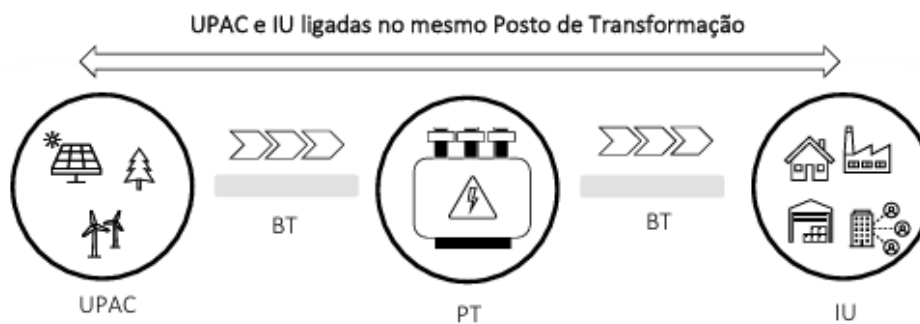
Figura 14 - Proximidade entre IU e UPAC com ligação ao mesmo PT em BT [5].
