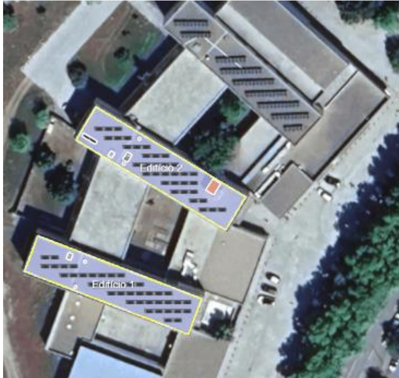
Figura 38 - Disposição dos módulos no edifício da ESE, Adaptada [18].
