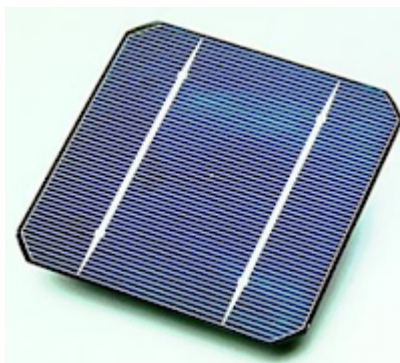
Figura 2-6 - Face frontal de uma célula FV de silício monocristalino. Fonte: engquimicasantosp.com.br
