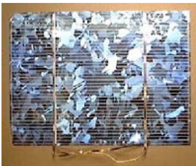
Figura 2-7 - Face frontal de uma célula FV de silício multicristalino. Fonte: engquimicasantosp.com.br
