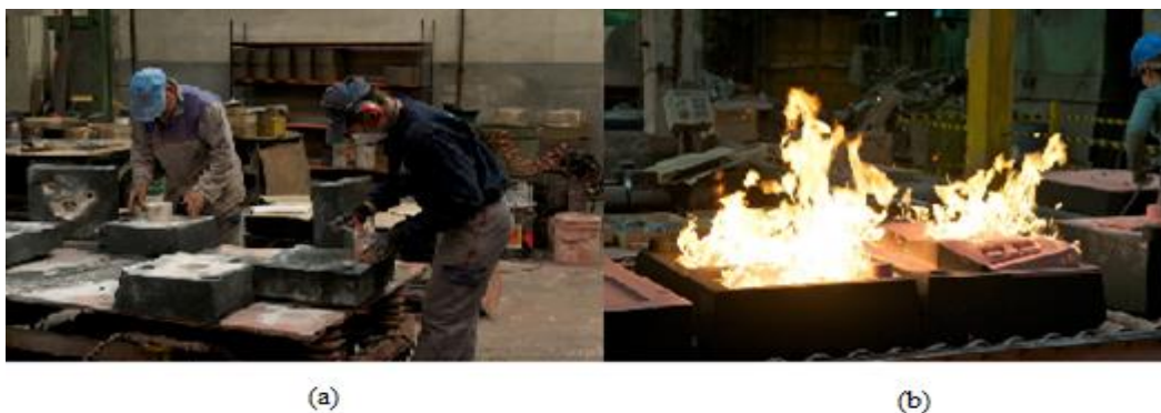
Figura 2.2 – Aplicação da tinta em (a) e queima de tinta na moldação em (b) com o objetivo de evaporar o solvente (álcool).
