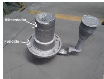
Figura 2.7 – Peça com alimentador para controlar os rechupes nas peças fundidas.
