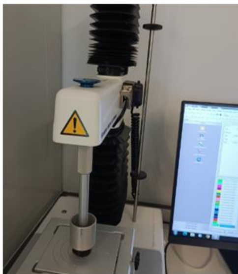
Figura 8. Texturómetro utilizado nas determinações da textura das gomas (Fonte: Autor, 2024).
