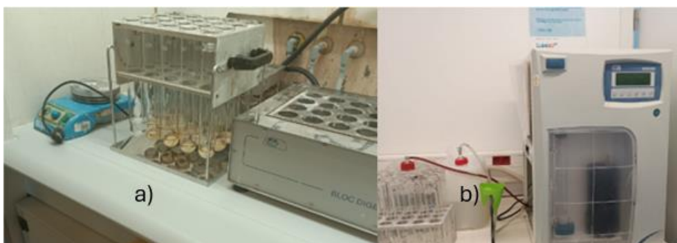
Figura 11. Equipamento utilizado na determinação da proteína: a) Digestor e b) Destilador.
