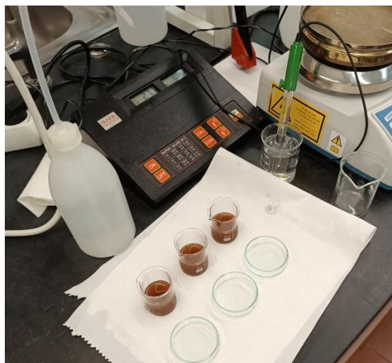
Figura 10. Soluções prontas para medir o pH e o medidor de pH utilizado nas experiências (Fonte: Autor).
