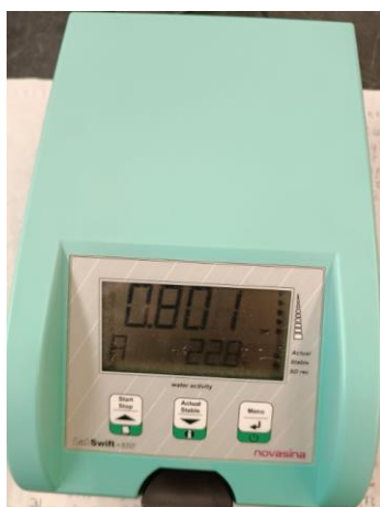
Figura 9. Medidor da atividade da água utilizado nas determinações (Fonte: Autor).
