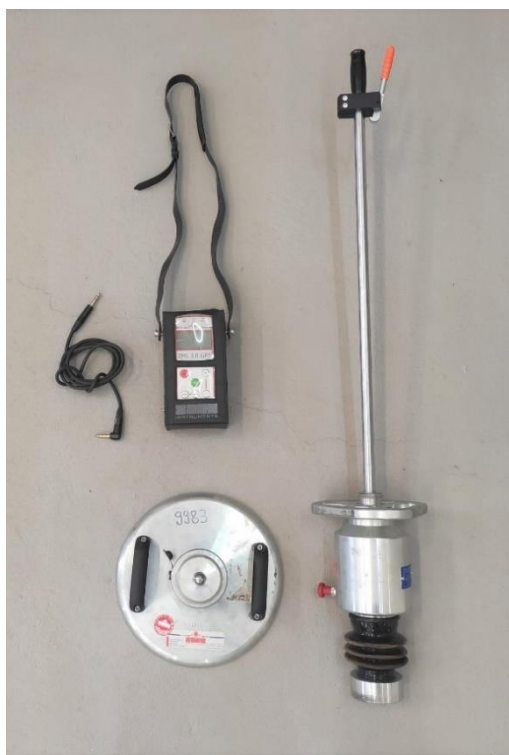
Figura 29 - Componentes do ZFG 3.0 utilizados no ensaio do Light Weight Deflectometer (LWD)
