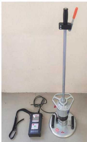
Figura 30 - ZFG 3.0 montado utilizado no Light Weight Deflectometer (LWD)
