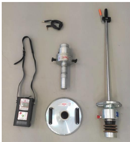
Figura 31 - Componentes do ZFG 3.0 utilizados no ensaio do CBR dinâmico
