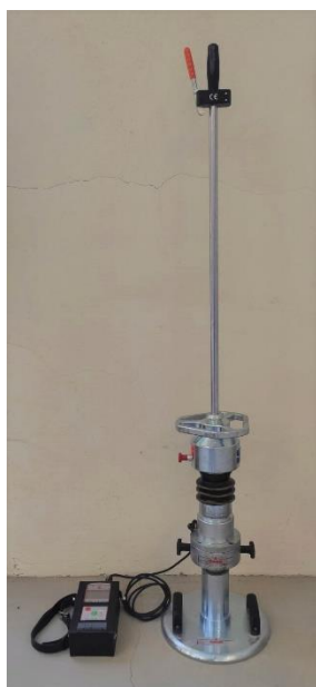
Figura 32 - ZFG 3.0 montado utilizado no CBR dinâmico
