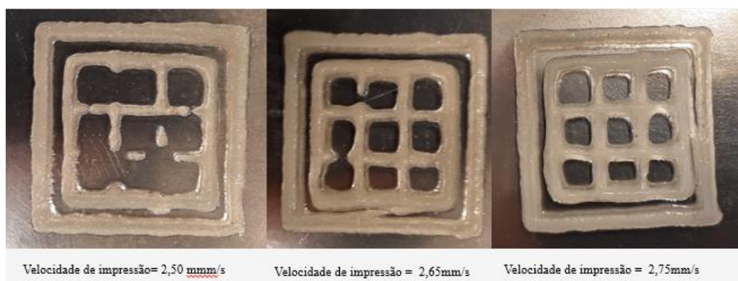
Figura 36. Cubo com apenas uma camada de dimensões 10x10 mm impressos da amostra M1
