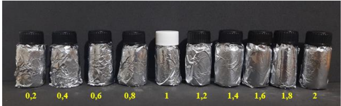
Figura 33. Dez concentrações (g/L) conhecidas de vitamina D3 dissolvidas em metanol para construção da curva padrão.
