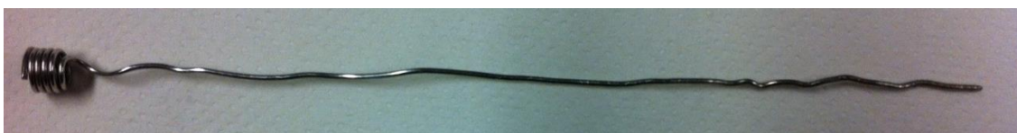
Figura 28 – Contra eletrodo de platina em espiral
