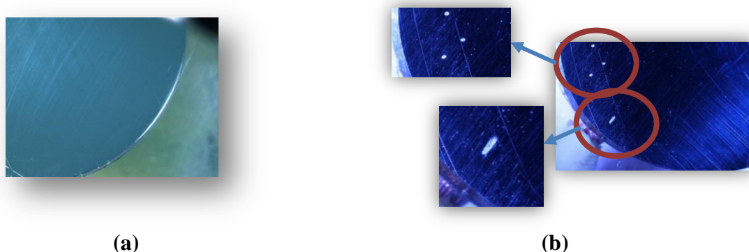
Figura 53 – Imagem obtida ao microscópio ótico da superfície da amostra de níquel após 8 dias de imersão em solução de: (a) NaCl 0.5M (semelhante para LiCl 0.5M e KCl 0.5M) e (b) CsCl 0.5M
