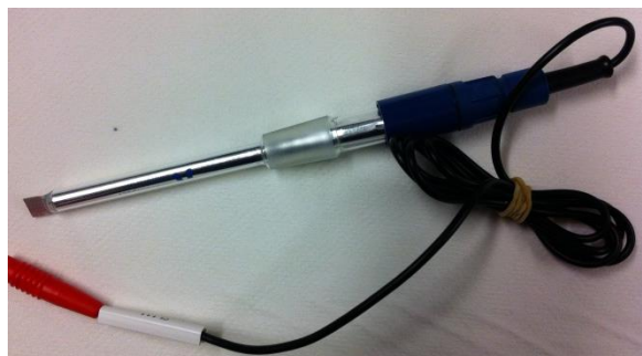
Figura 27 – Eletrodo de referência de platina
