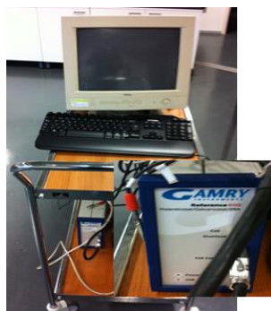
Figura 30 – Potenciostato/Galvanostato Reference 600 da empresa Gamry Instruments
