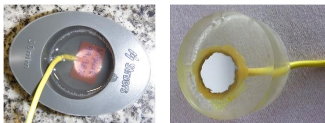
Figura 25 – Amostra utilizada nos ensaios eletroquímicos
