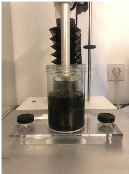
Figura 7 - Texturómetro empregado para avaliação de textura dos hidrogéis de S. platensis
