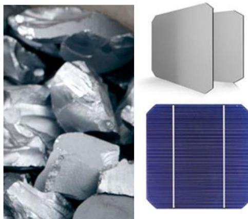
Figura 10 - Silício purificado (esquerda), silício fatiado (em cima) e célula monocristalina (embaixo)
