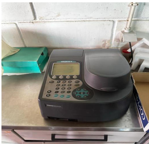
Figura 6: Equipamento utilizado para medir a absorbância de Boro.
