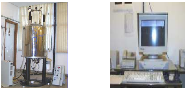
Figura 1.15 - Aparelho de RMN composto por: aparelho de ressonância (a) e um computador (b). [34]
