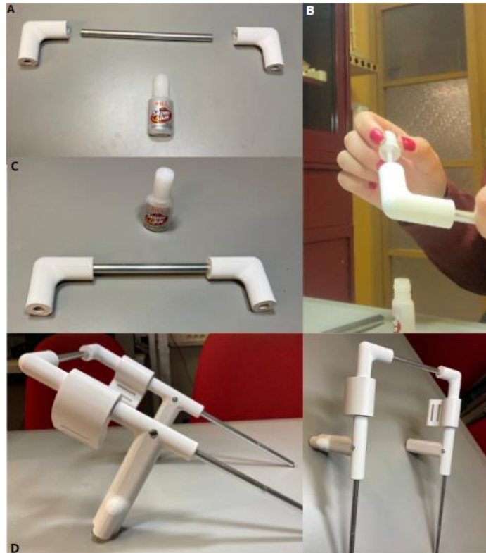
Figura 45 - A) Peças a serem acopladas; B) Passando a super cola para fixação das extremidades; C) Peças acopladas; D) Haste traseira acoplada ao resto da estrutura.
