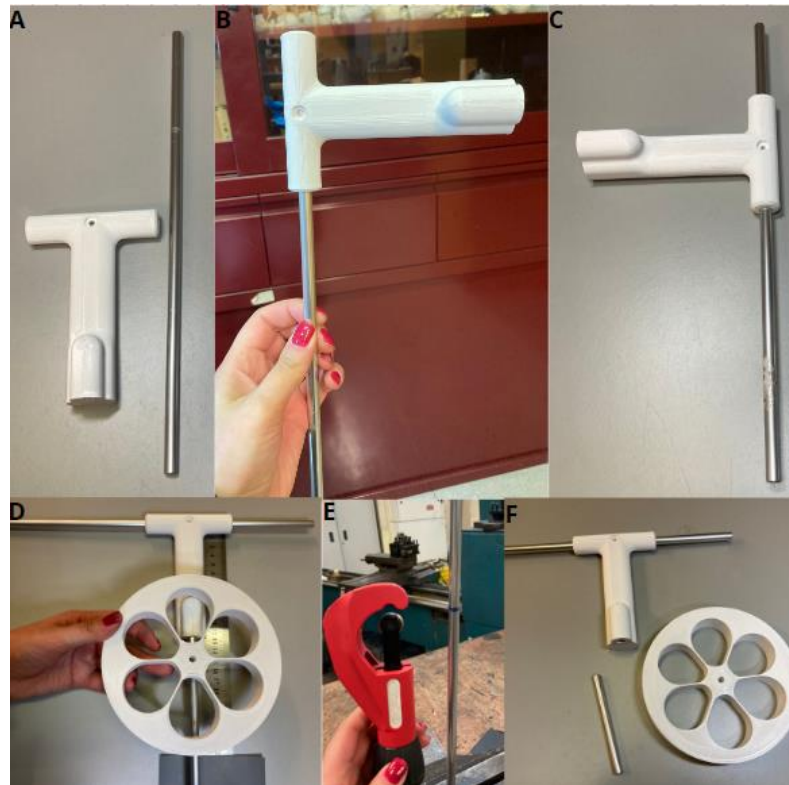
Figura 41 - A) Haste e suporte; B) C) Acoplamento da haste no suporte; D) Retirando medidas de acordo com a altura do cão; E) Realizando o corte do alumínio; F) Alumínio cortado pronto para montagem.
