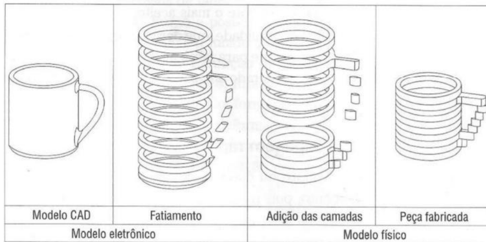
Figura 2- Representação das principais etapas do processo de manufatura por camada.
