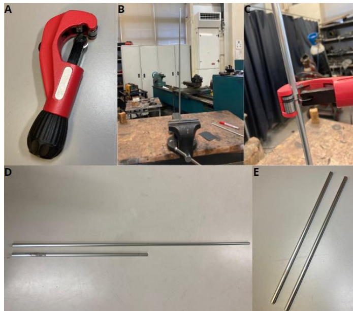
Figura 40 - A) Corta-tubos; B) Fixação do alumínio na morsa de bancada; C) Corte do alumínio; D) Realizado o corte de uma das hastes de sustentação; E) As duas hastes cortadas.
