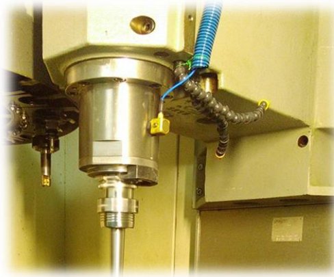
Figura 31: Ferramenta de fresagem na máquina ferramenta cnc com o acelerómetro triaxial instalado na arvore.
