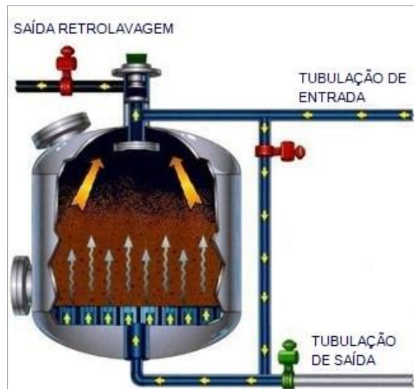
Figura 14: Esquema de lavagem de filtro ou retrolavagem (Salcedo, Testezlaf, & Mesquita, 2011).
