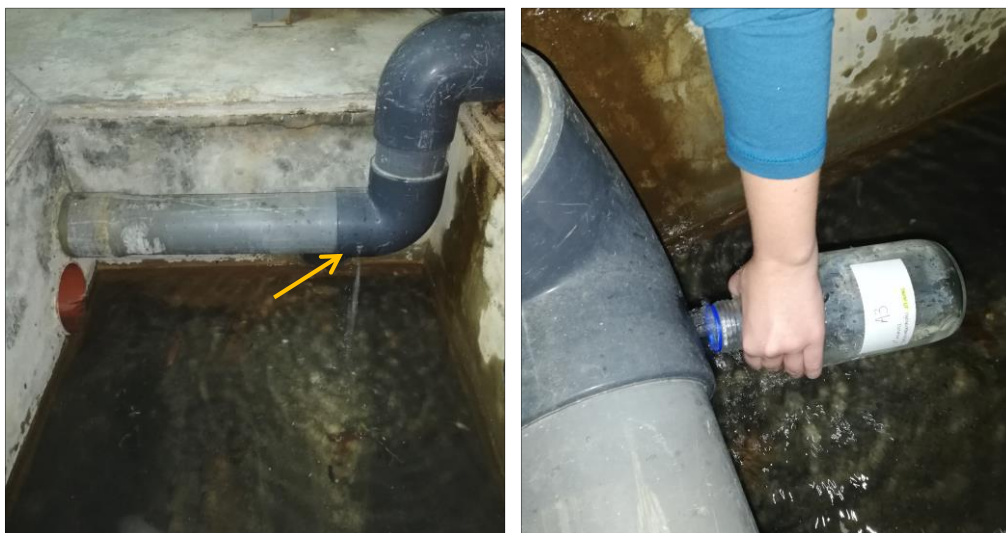
Figura 42: Coleta de amostras da água da lavagem dos filtros: (a) Abertura na tubagem de descarte de água; (b) Coleta de amostra de água.
