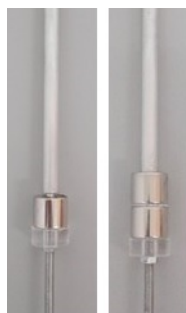
Figura 3.5: Haste com um/dois íman(es) permanente(s) de neodímio
