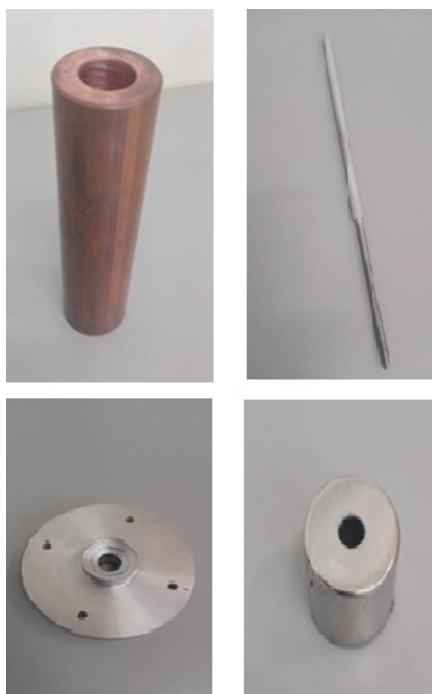
Figura 3.4: Tubo de cobre/haste de alumínio/topo/íman
