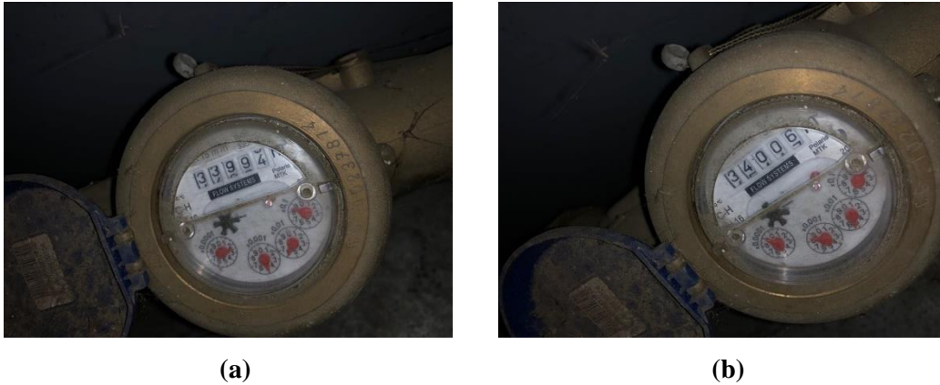
Figura 3.8: Leitura de água no contador: (a) Antes do ciclo de rega; (b) Depois do ciclo de rega.
