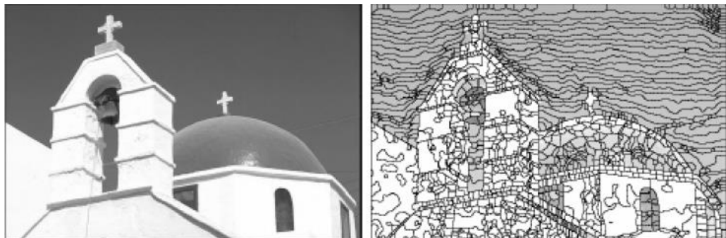
Figura 4.5: À esquerda: imagem original. À direita: resultado da aplicação da segmentação watershed [39].
