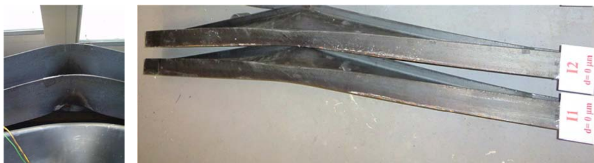
Figura 53 – Deformação final dos elementos I1 e I2.
