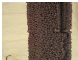
Figura V.144 – Formação de uma fractura na camada.
