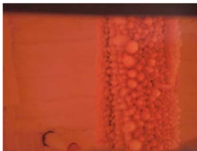
Figura V.233 – Camada intumescente formada.
