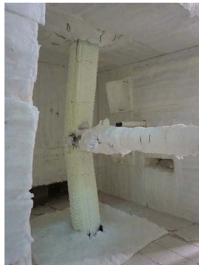
Figura V.125 – Deformação final imposta ao elemento.
