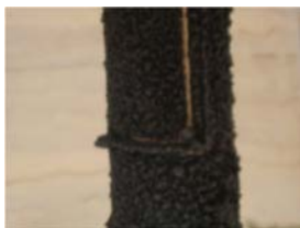
Figura V.191 – Formação da camada intumescente.
