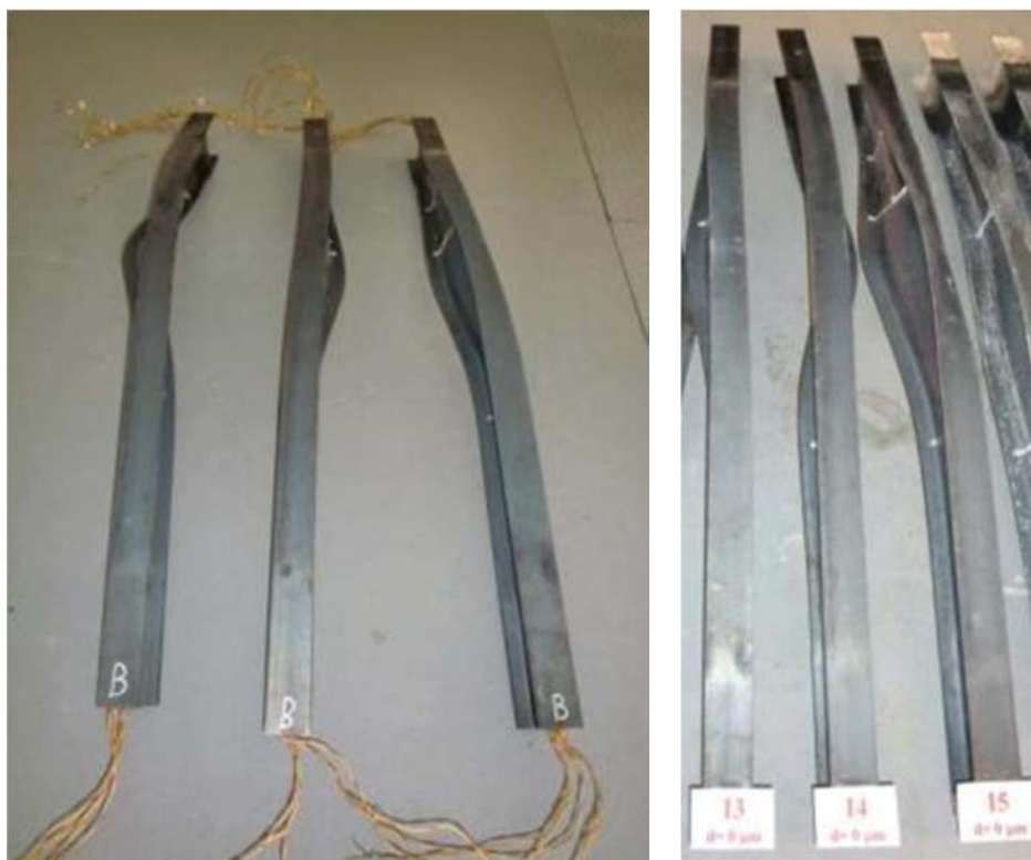
Figura 57 - Deformação imposta nos elementos IPE em condições de incêndio, sem protecção.
