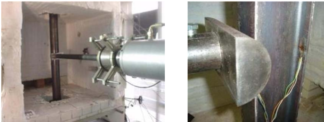
Figura 23 - Esquema experimental da aplicação da carga.
