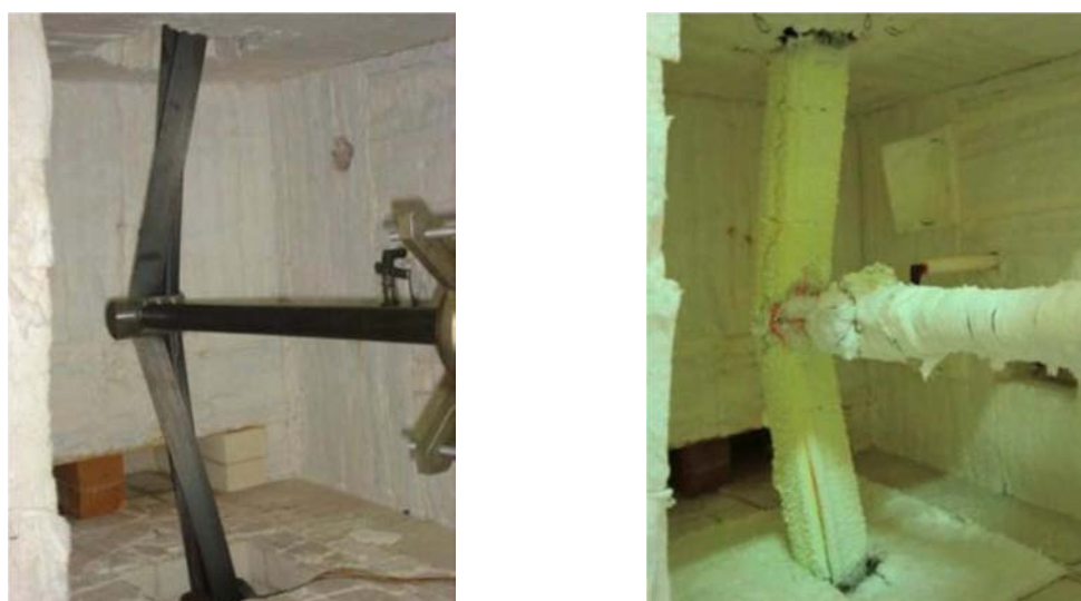
Figura 33 – Estado limite último do ensaio I3 e do ensaio S6.
