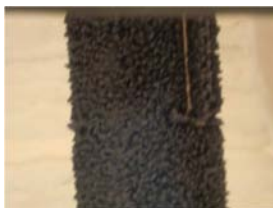
Figura V.143 – Formação da camada intumescente.
