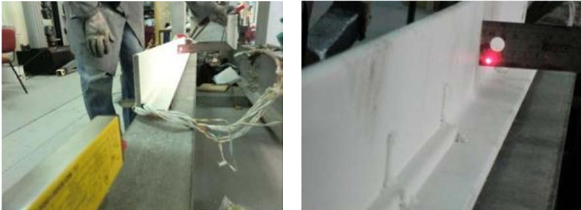
Figura 52 – Leitura da imperfeição geométrica de cada elemento.
