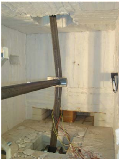
Figura V.202 – Início da instabilização lateral.
