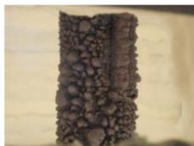
Figura V.176 – Formação da camada intumescente.
