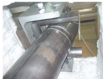
Figura V.156 – Observação da rótula imposta ao elemento.
