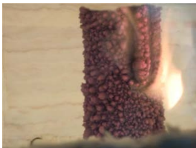
Figura V.172 – Formação da camada de protecção intumescente.
