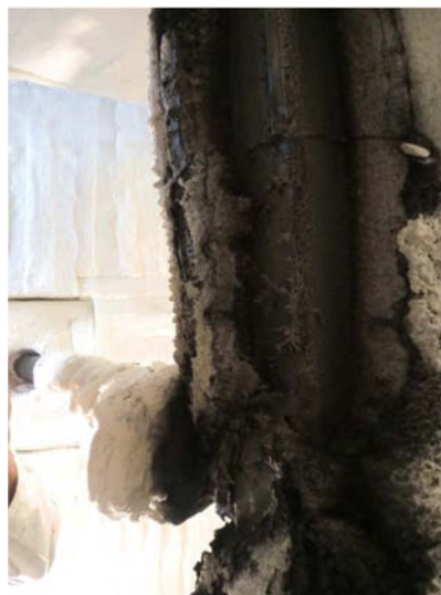
Figura V.148 – Visualização da retracção da camada intumescente.
