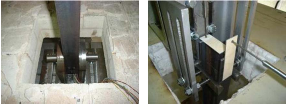
Figura 22 - Apoios experimentais, (duplo à esquerda, simples à direita).
