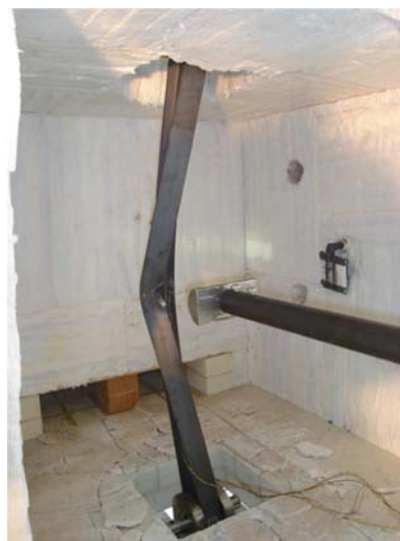
Figura V.69 – Deformação final do elemento.
