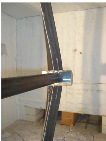
Figura V.204 – Deformação do elemento no final do ensaio.
