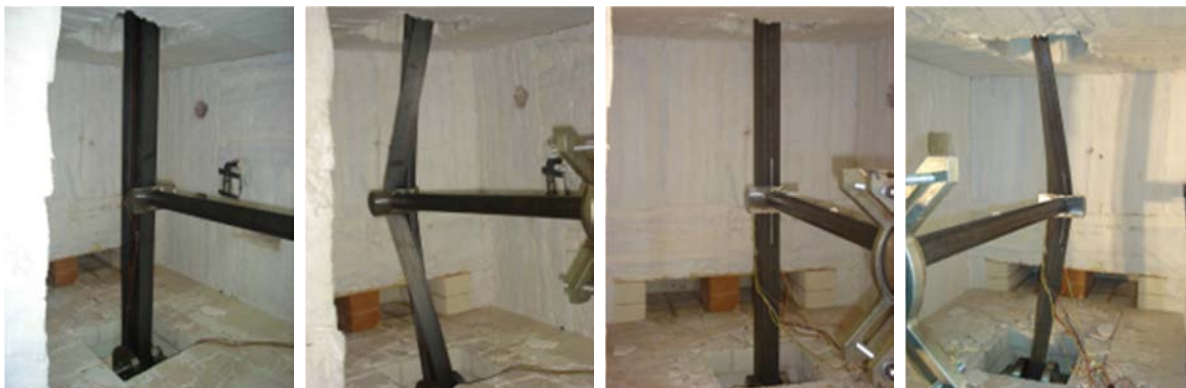
Figura 16 – Representação do fenómeno de encurvadura lateral verificado em 2 ensaios.
