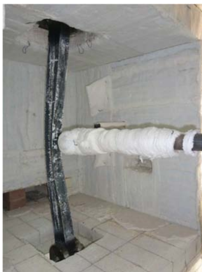
Figura V.89 – Deformação final do elemento.
