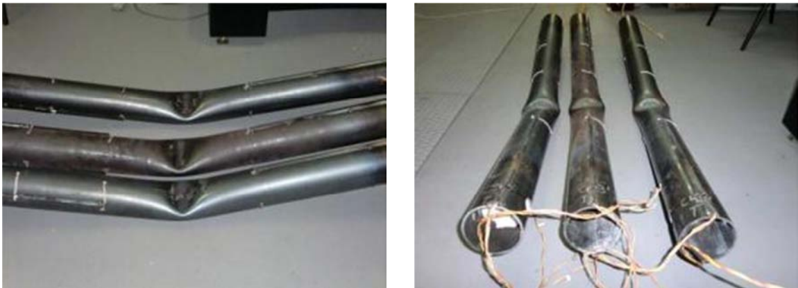
Figura 59 – Deformação imposta aos elementos de secção CHS, ensaiados ao fogo sem protecção.
