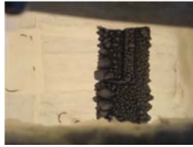
Figura V.186 – Fase intermédia da formação da camada.
