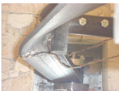
Figura V.206 – Vista superior da deformação final.
