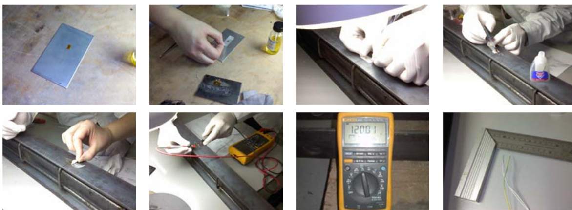
Figura 40 – Fase de colagem do extensómetro no elemento.
