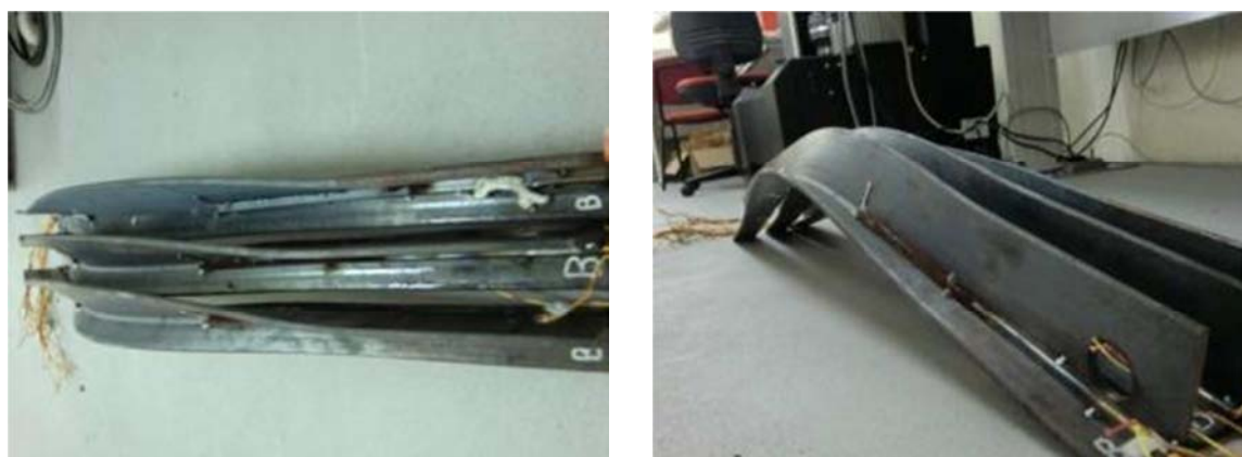
Figura 60 - Deformação imposta aos elementos LNP em ambiente de fogo, sem protecção.
