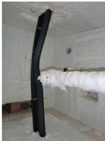
Figura V.75 – Deformação imposta no elemento.
