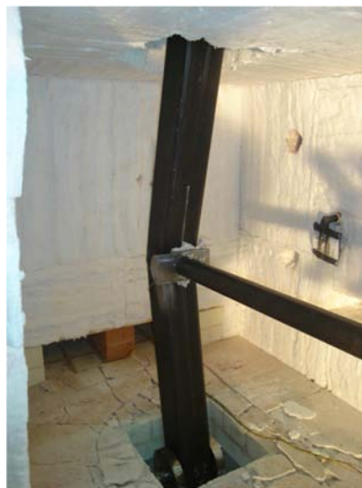
Figura V.111 – Elemento no seu estado de ruptura.
