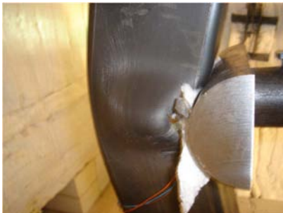
Figura V.114 – Rótula plástica formada pela ruptura.
