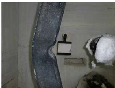
Figura V.134 – Rótula plástica imposta ao elemento depois do ensaio.
