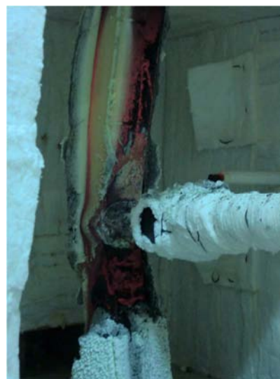
Figura V.142 – Visualização da retracção da camada intumescente, depois do ensaio terminado.
