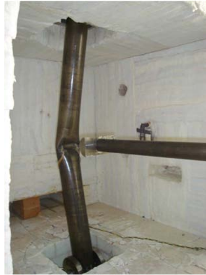
Figura V.150 – Deformação provocada ao elemento no final do ensaio.
