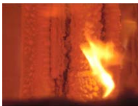
Figura V.107 – Camada intumescente formada.
