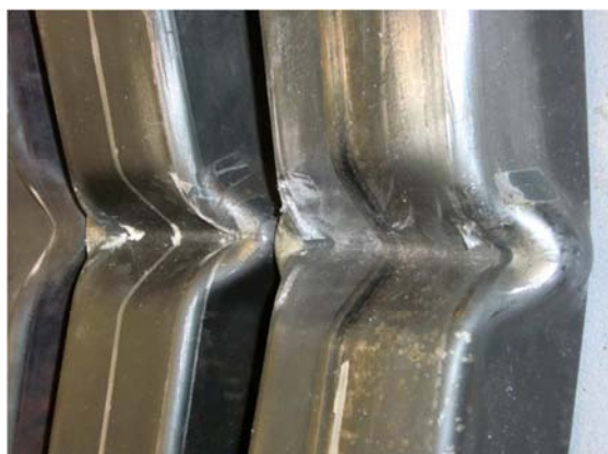
Figura 54 – Deformação resultante da ruptura nos ensaios S1 e S2.
