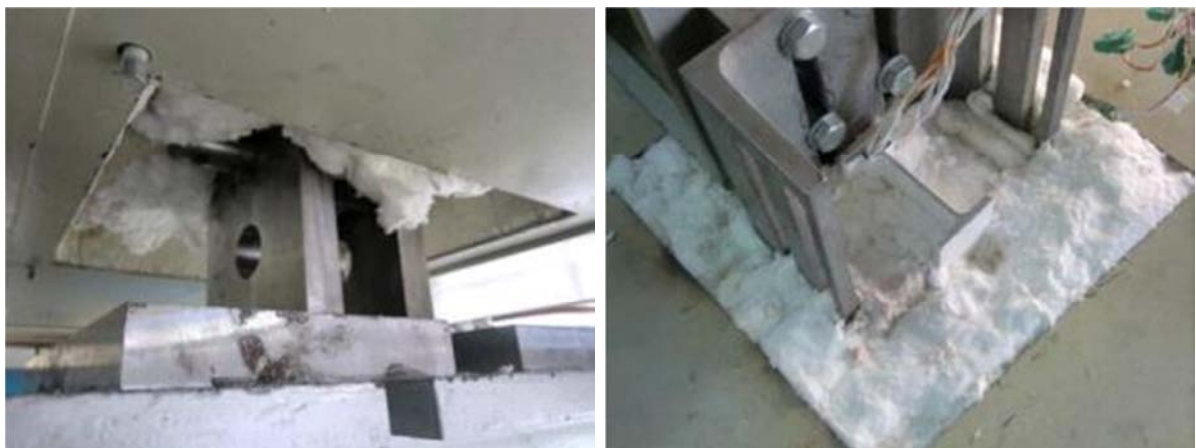
Figura 28 – Demonstração do isolamento nos apoios das extremidades.
