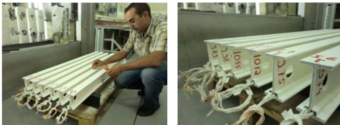
Figura 51 – Observação do controlo dimensional da espessura de tinta nos elementos.
