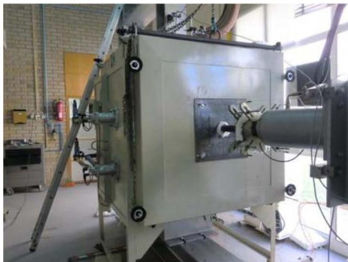
Figura 29 – Sistema pronto a iniciar um ensaio ao fogo.
