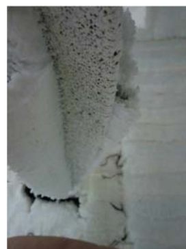
Figura V.241 – Pormenor da zona de retracção da camada intumescente.
