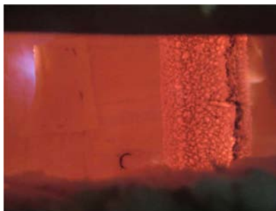
Figura V.131 – Camada intumescente já totalmente formada.
