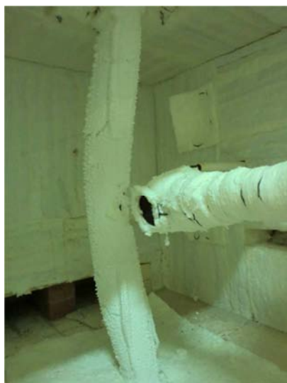
Figura V.230 – Final do ensaio, com o elemento envolvido pela camada intumescente.
