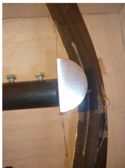
Figura V.205 – Pormenorização da rotação lateral da secção.
