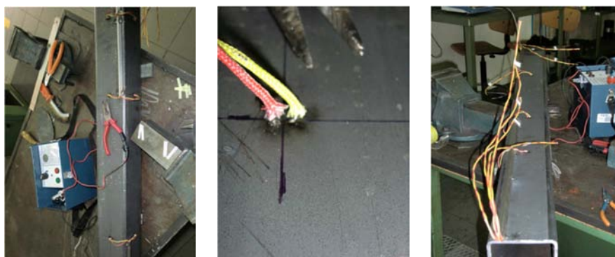
Figura 46 – Soldadura dos fios termopares.
