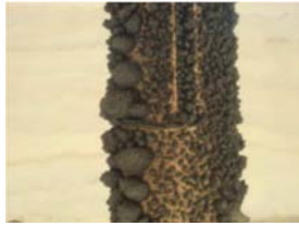
Figura V.185 – Formação da camada intumescente.
