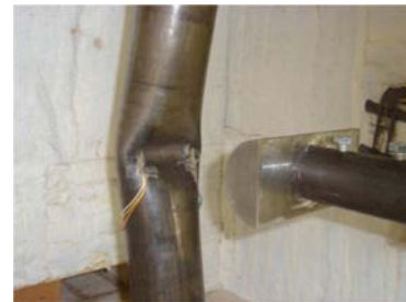
Figura V.153 – Observação da rótula imposta ao elemento.
