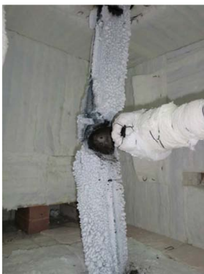
Figura V.164 – Estado de deformação do elemento no final do ensaio.
