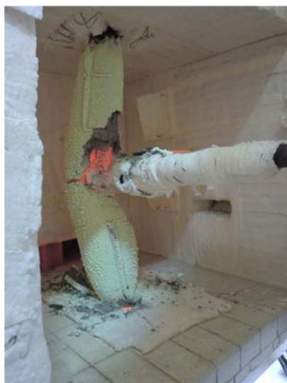
Figura V.200 – Final do ensaio, visualizando a camada intumescente.
