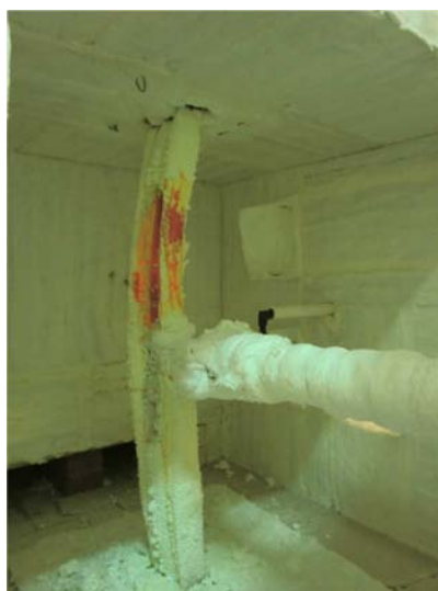
Figura V.93 – Deformação sofrida pelo elemento.
