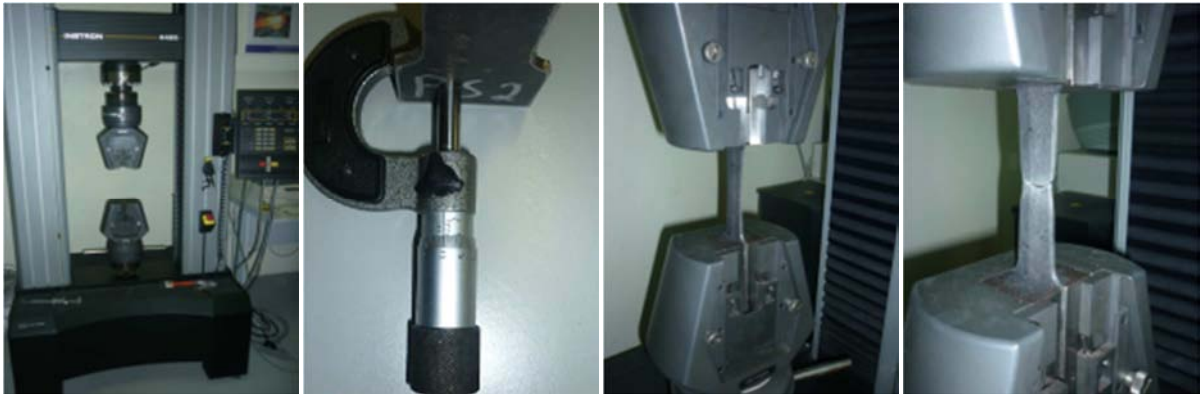
Figura 8 – Ensaio realizado de teste de resistência à tracção dos provetes.
