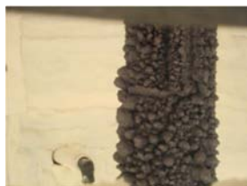
Figura V.166 – Formação da camada intumescente.
