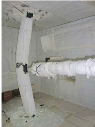
Figura V.221 – Deformação imposta ao elemento no final do ensaio.
