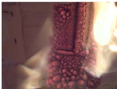
Figura V.182 – Camada intumescente já formada.
