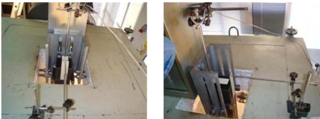
Figura 24 - Posição dos LVDT's no elemento.
