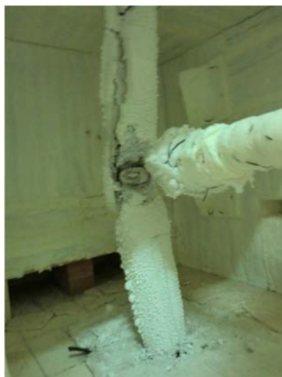
Figura V.180 – Final do ensaio, com a visualização da camada intumescente.
