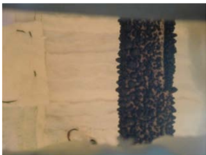
Figura V.232 – Início da reacção da tinta intumescente.
