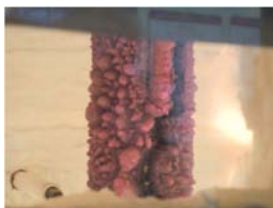
Figura V.177 – Início da retracção da camada.
