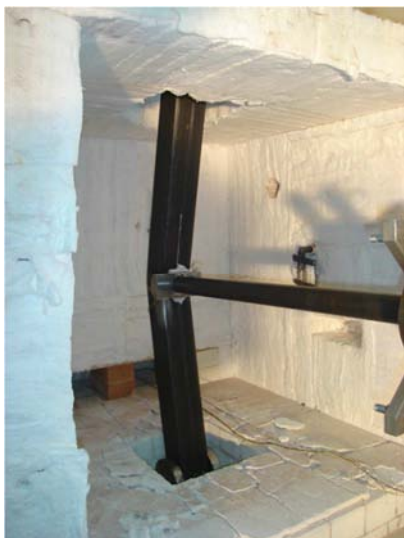
Figura V.110 – Elemento próximo da ruptura.
