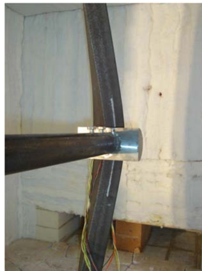
Figura V.203 – Deformação provocada pela instabilização lateral do elemento.
