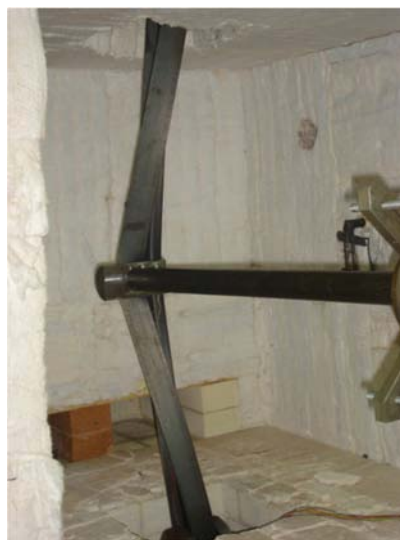
Figura V.65 – Elemento no seu estado de ruptura.
