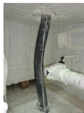
Figura V.220 – Deformação final, imposta ao elemento.
