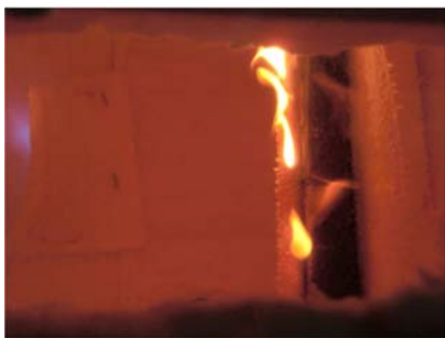
Figura V.236 – Início da retracção da camada intumescente.
