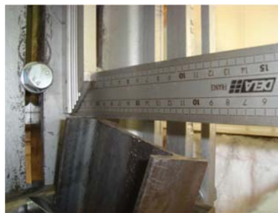
Figura V.67 – Estado de rotação do topo do elemento.
