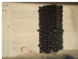
Figura V.196 – Formação da camada intumescente.
