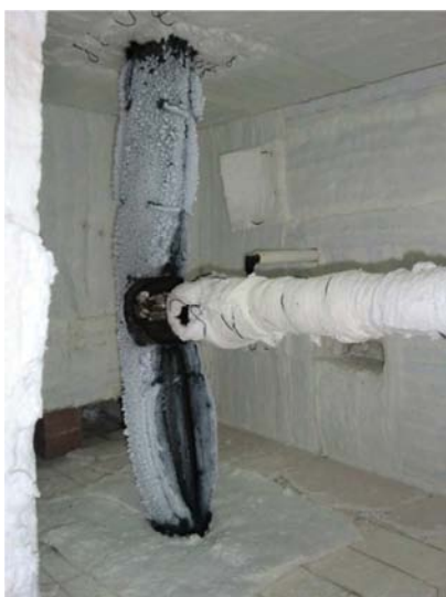
Figura V.183 – Final do ensaio, com a visualização da camada intumescente.
