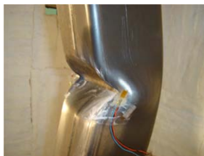
Figura V.113 – Estado de deformação do elemento.
