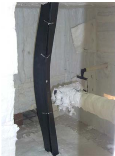
Figura V.213 – Deformação final imposta ao elemento.
