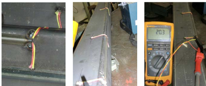
Figura 47 – Acondicionamento dos elementos com os termopares instalados.
