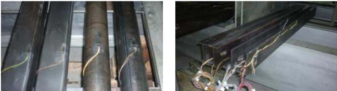
Figura 37 – Elementos com extensómetros instalados.
