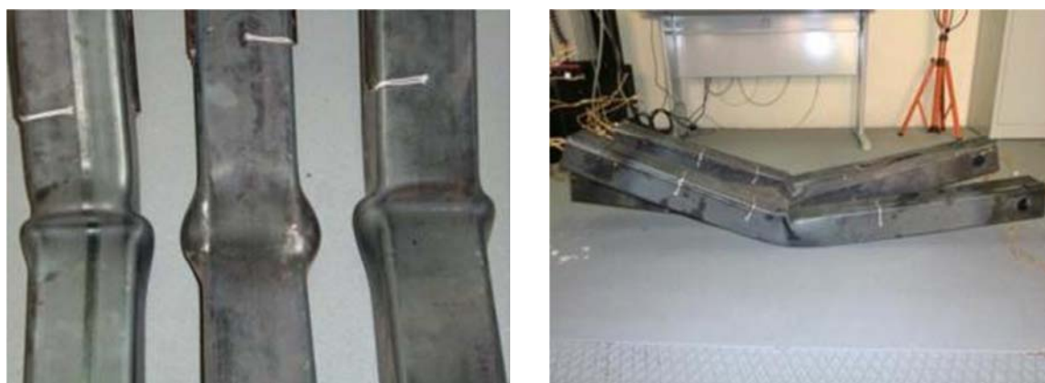
Figura 58 - Deformação imposta aos elementos de secção SHS ao fogo, sem protecção.
