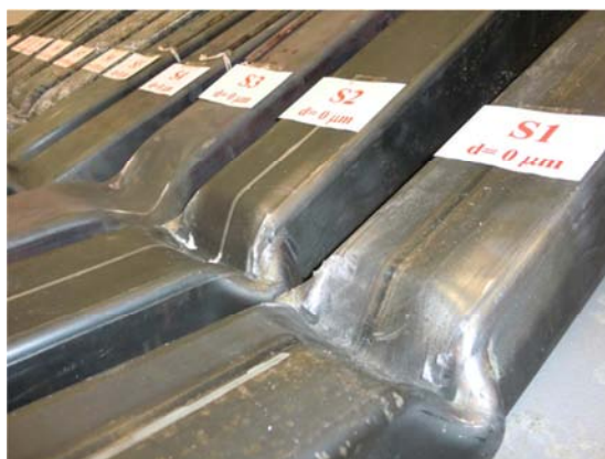
Figura 54 – Deformação resultante da ruptura nos ensaios S1 e S2.
