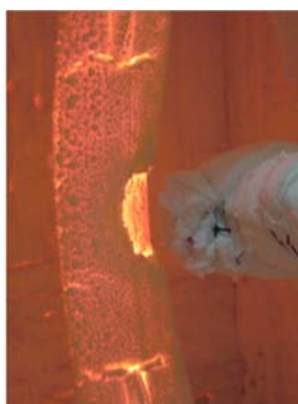
Figura V.219 – Zona do elemento que sofreu encurvadura lateral.
