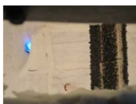
Figura V.83 – Formação da camada intumescente.
