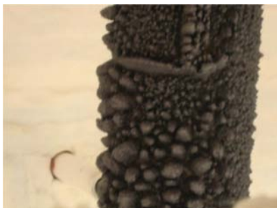
Figura V.181 – Formação da camada de protecção intumescente.
