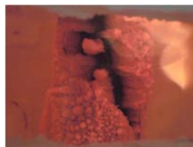
Figura V.198 – Retracção da camada a evoluir.
