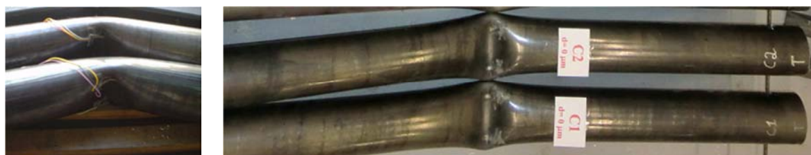
Figura 55 – Deformação provocada aos ensaios C1 e C2.
