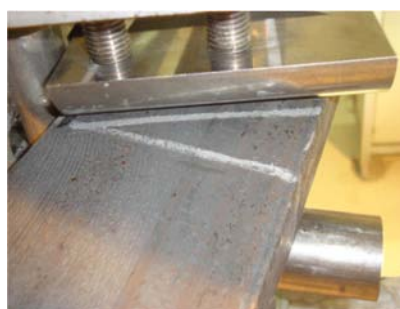
Figura V.207 – Rotação no topo do elemento.
