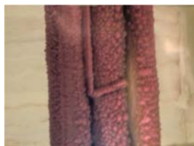
Figura V.100 – Camada intumescente formada.
