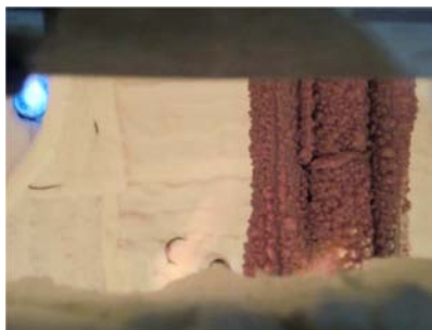
Figura II.87 – Camada intumescente formada.
