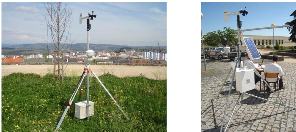
Figura 13 - Estaciones Meteorológicas Automáticas de la red de monitorización del clima de la ciudad de Bragança
