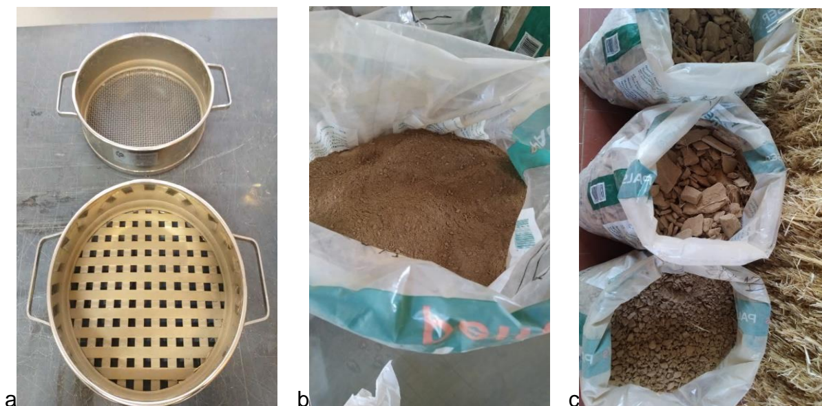
Figura 26 – Crivagem do solo utilizado no ensaio experimental: a. Crivos de malhas 2mm e 0,75mm b. Solo crivado para amostragem c. Solo crivado (material grosseiro e médio)
