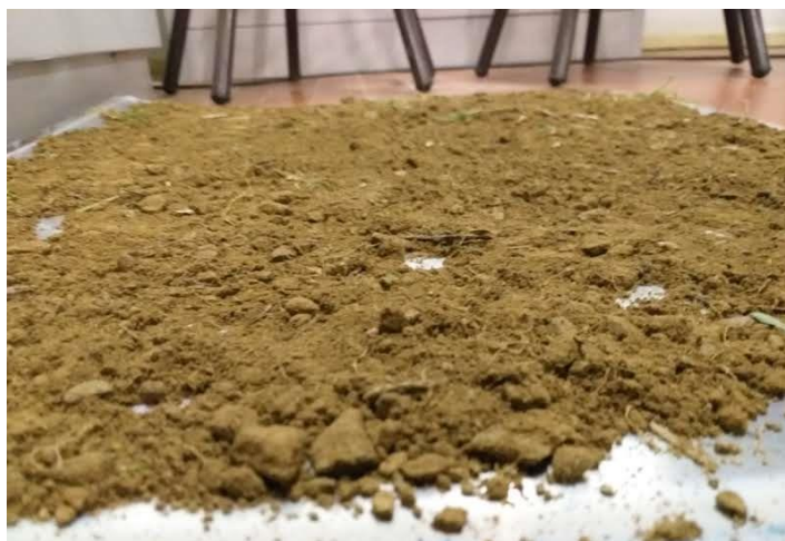
Figura 25 – Secagem do solo antes da montagem dos tabuleiros
