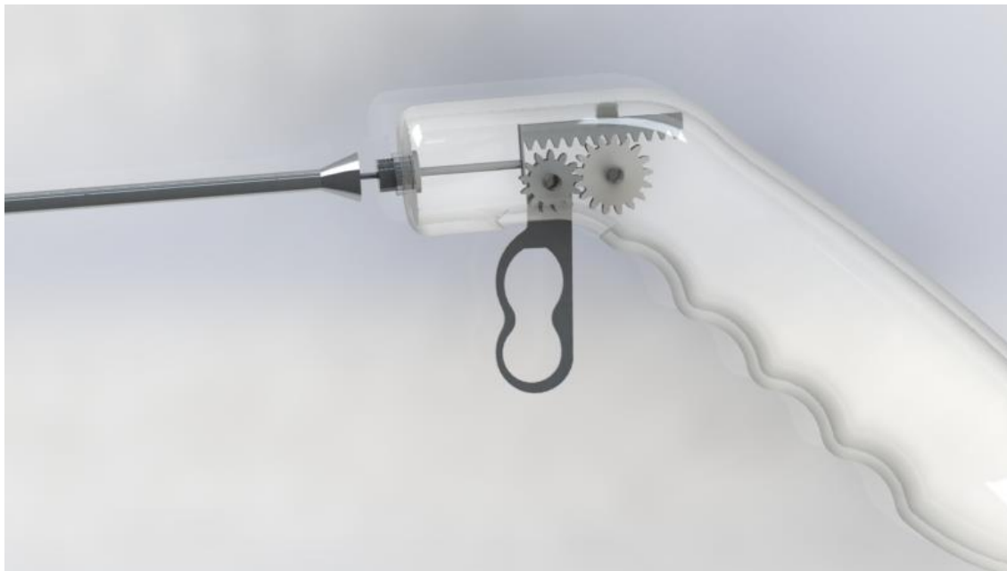
Figura 40 - Acoplamento do sistema de engrenamento e do manípulo
