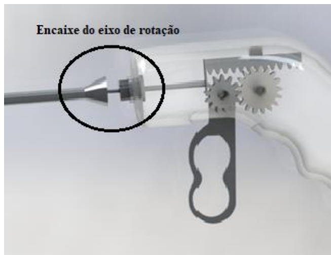
Figura 41 - Encaixe do eixo de rotação
