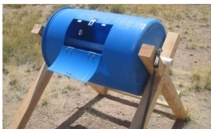
Figura 7. Aproveitamento de um barril usado, servindo de compostor rotativo (Hodgson, 2015)
