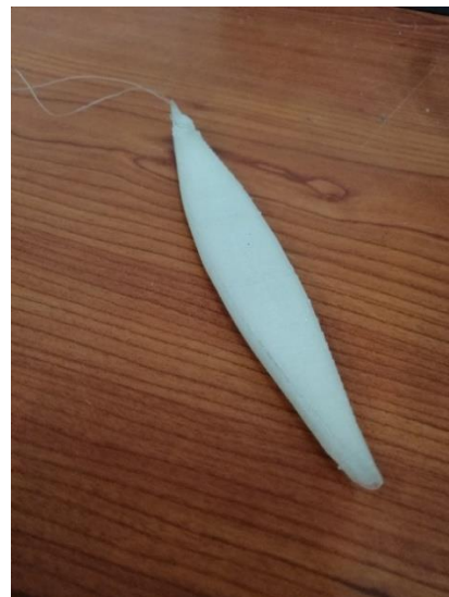
Figura 23 – Modelo impresso na impressora 3D ultimaker
