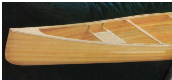
Figura 11 – Modelo de canoa de ripas de madeira de cedro
