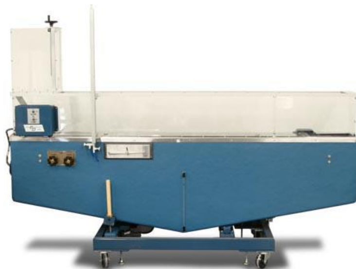
Figura 8 – canal hidráulico de laboratório [21]
