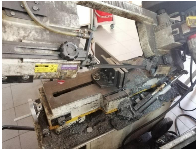
Figura 28 – Corte do varão de aço na serra de fita
