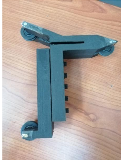
Figura 25 - Mecanismo tipo 2 impresso na impressora 3D FDM Buil R
