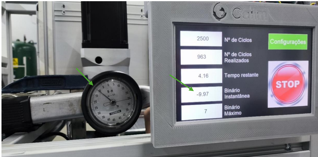
Figura 47 - Confirmação do binário de 10 Nm no sentido horário
