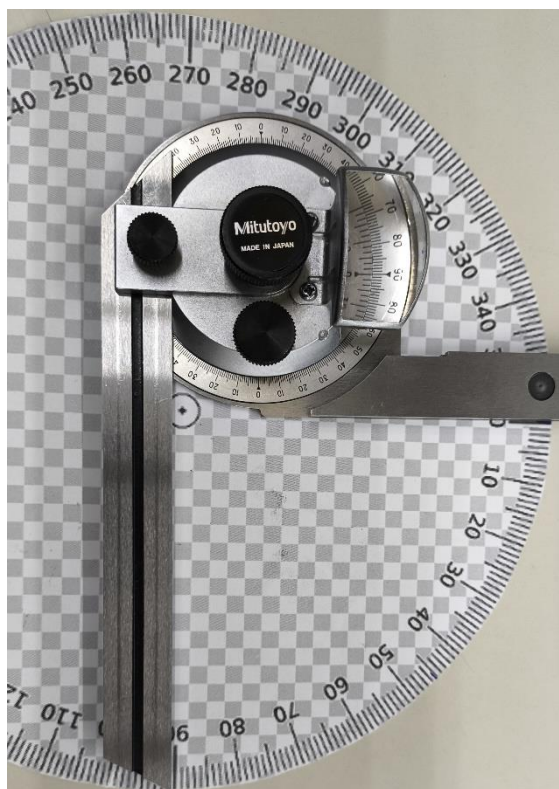
Figura 72 - Verificação com uma suta calibrada para a validação do valor de 90°
