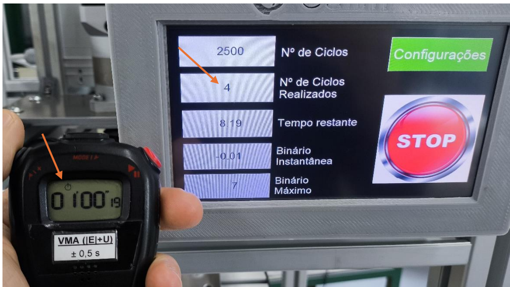
Figura 55 - Contabilização de número de ciclos em 1 minuto de ensaio
