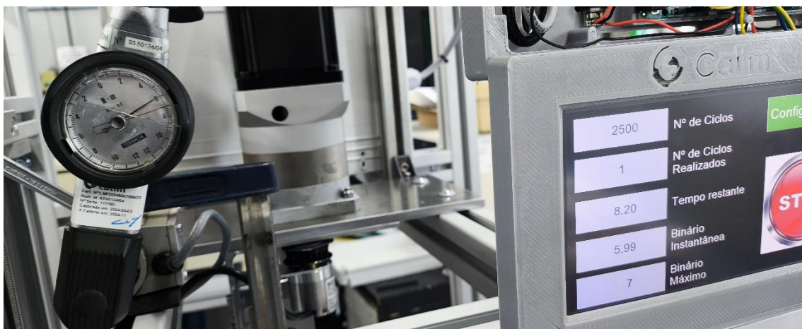
Figura 62 - Confirmação do binário de 6 Nm no sentido anti-horário
