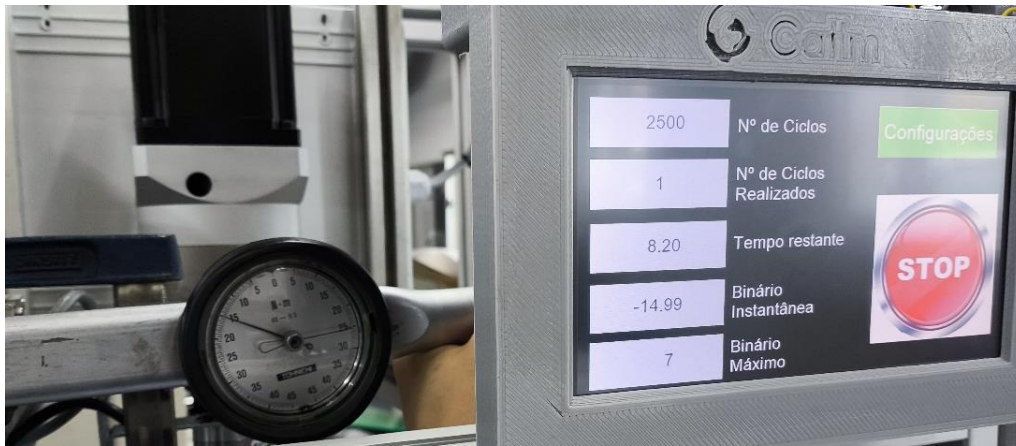
Figura 69 - Confirmação do binário de 15 Nm no sentido horário
