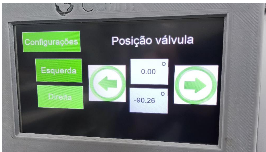
Figura 71 - Valor da posição a 90° mostrado pelo display
