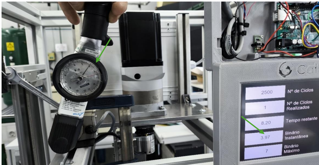
Figura 46 - Confirmação do binário de 4\text{Nm} no sentido anti-horário
