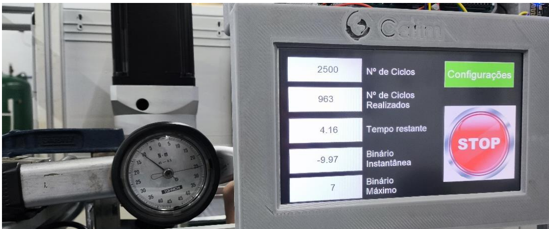
Figura 68 - Confirmação do binário de 10 Nm no sentido horário
