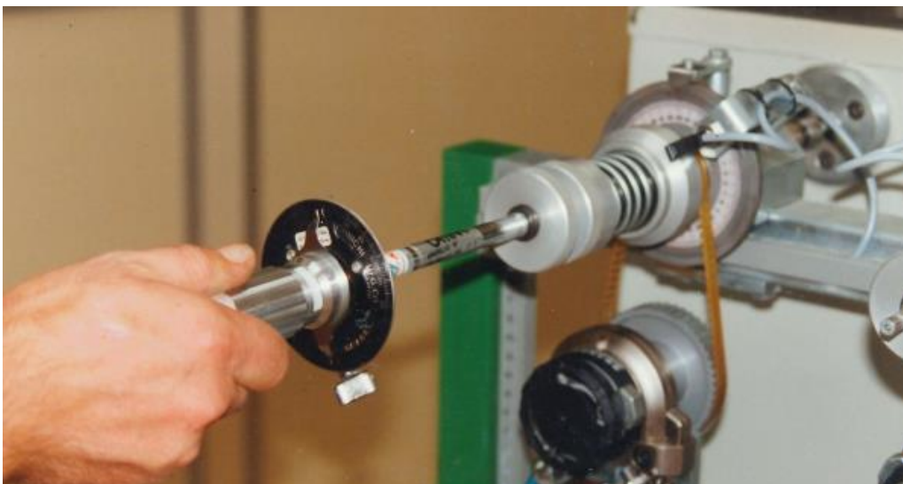
Figura 5 - Chave dinamométrica para regular o binário de manobra máximo
