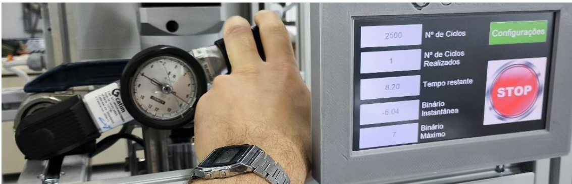
Figura 67 - Confirmação do binário de 6 Nm no sentido horário
