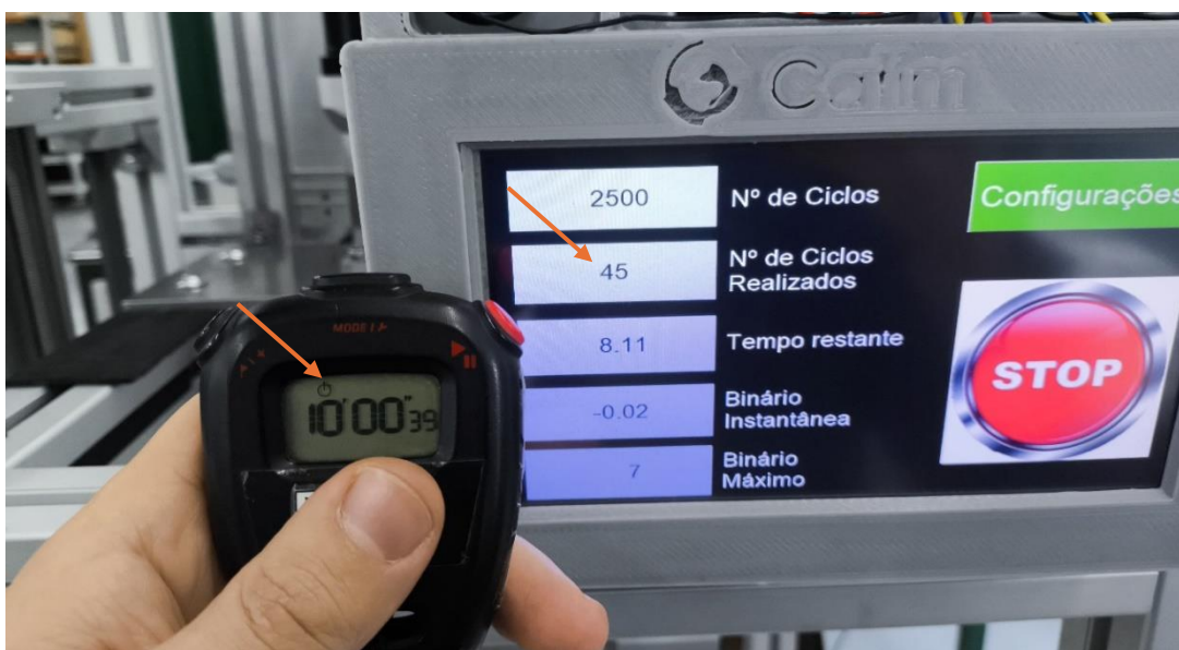
Figura 56 - Contabilização de número de ciclos em 10 minuto de ensaio
