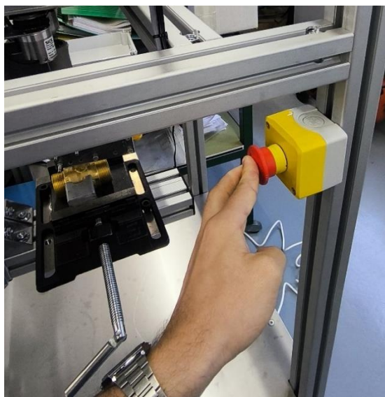
Figura 16 - Botoneira de emergência
