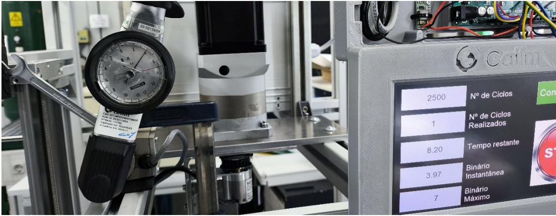
Figura 63 - Confirmação do binário de 4 Nm no sentido anti-horário
