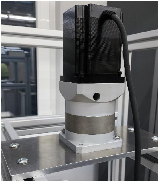
Figura 26 - Montagem do motor com a caixa redutora
