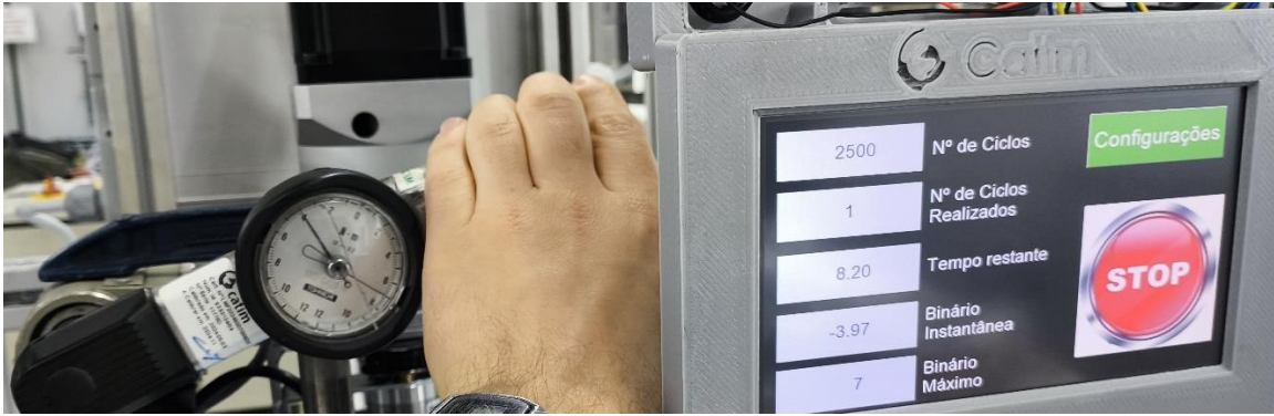
Figura 66 - Confirmação do binário de 4 Nm no sentido horário
