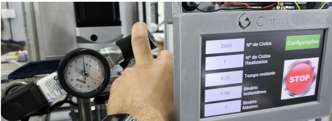
Figura 65 - Confirmação do binário de 2 Nm no sentido horário
