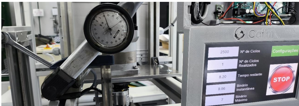
Figura 61 - Confirmação do binário de 10 Nm no sentido anti-horário
