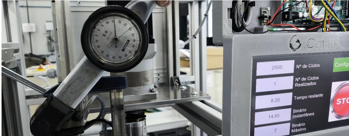
Figura 60 - Confirmação do binário de 15 Nm no sentido anti-horário
