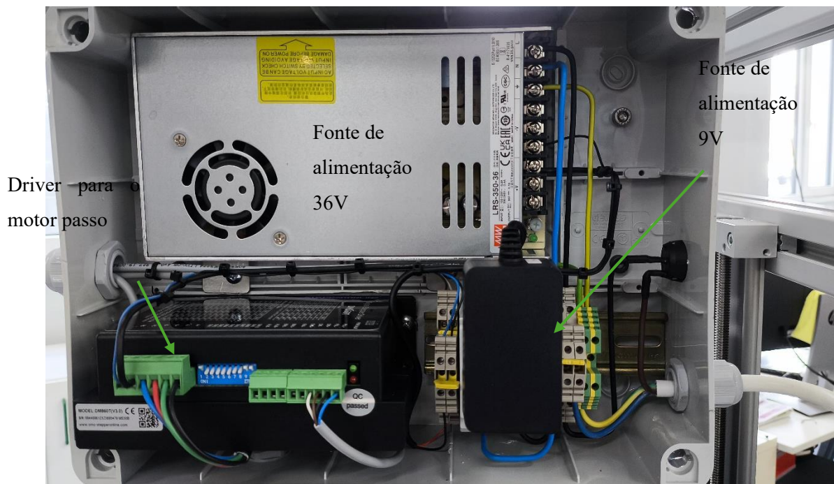
Figura 58 - Organização da instalação elétrica
