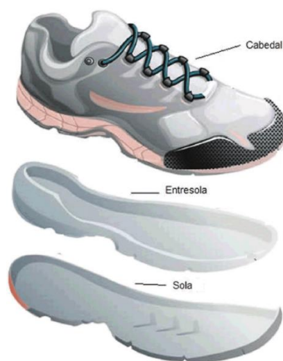
Figura 8 – Principal constituição do calçado: Cabedal, Entressola e Sola (Adaptado de (Zanolli, 2014)).
