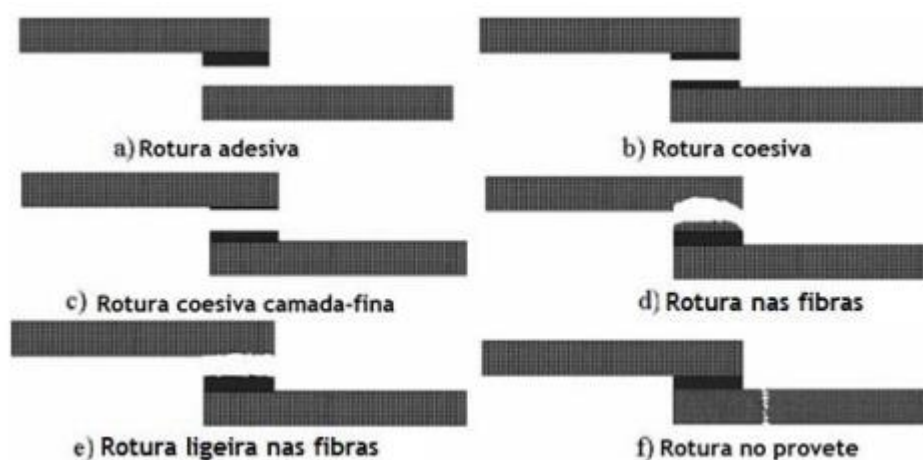
Figura 12 – Tipos de Ruptura em juntas adesivas [19]
