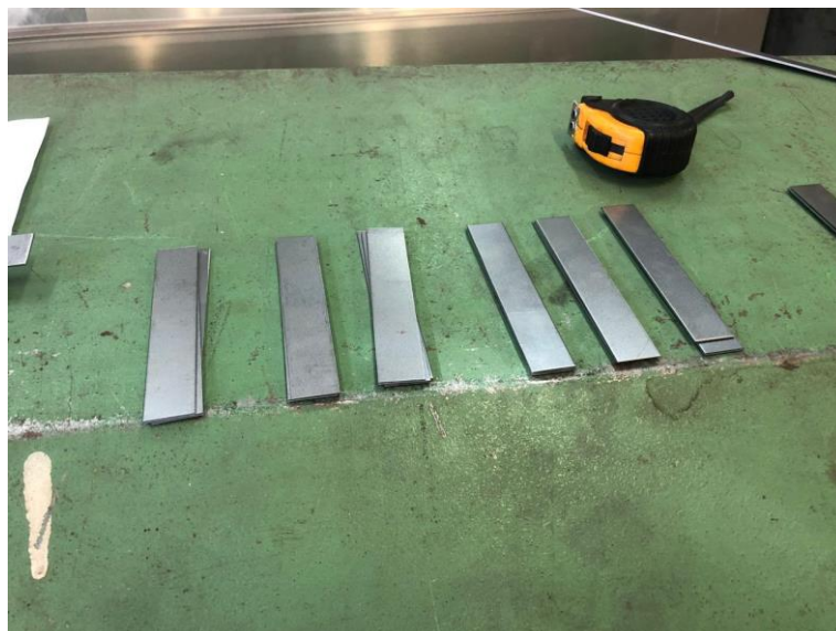
Figura 19 – Corpos de Prova cortados e preparados para utilização dos aderentes.
