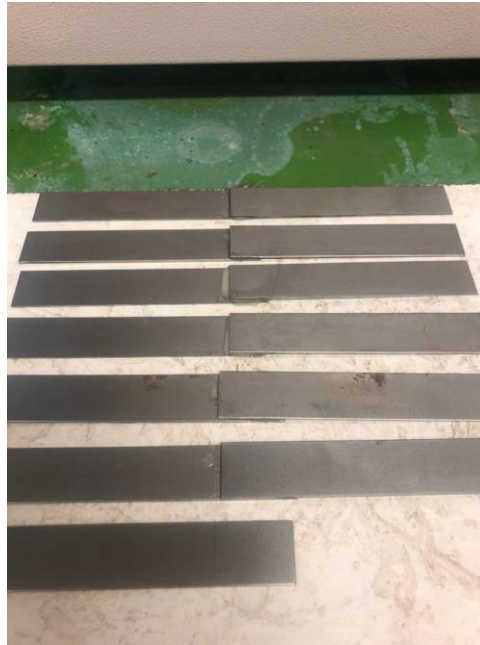
Figura 20 – Corpos de prova sendo colados
