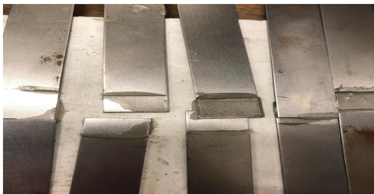
Figura 25 – Corpos de prova fraturados (cianoacrilato 12.5mm)
