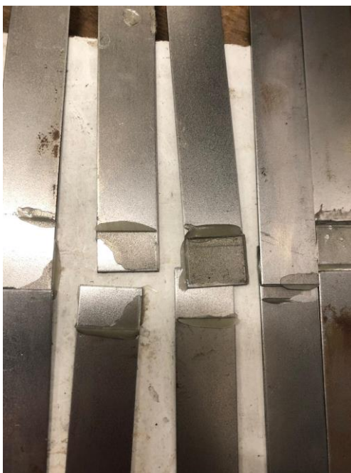
Figura 28 - Aderentes com testes de cianoacrilato de 12,5mm e espessura do adesivo 0,5mm
