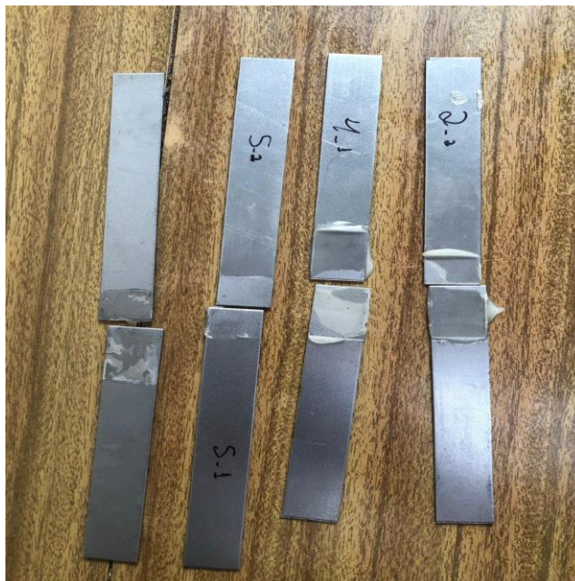
Figura 27 – Aderentes 5_1 e 5_2 epóxi de 12,5mm e 4_1 e 2_1 Cianocrilato de 25mm
