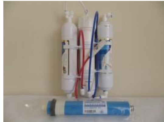
Figura 6 - Filtro de Osmose Reversa Utilizado no Processo
