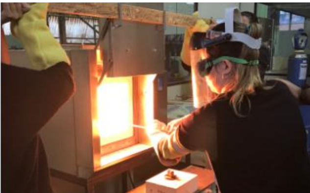
Fig. 1. Forno sendo usada para síntese do vidro. (Acervo próprio).
