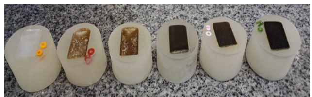
Fig. 2. Amostras do material após preparação metalográfica.
