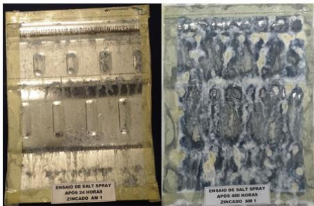
Fig. 1. Material zincado com corrosão branca após 24 e 480 h de exposição à névoa salina, respectivamente.
