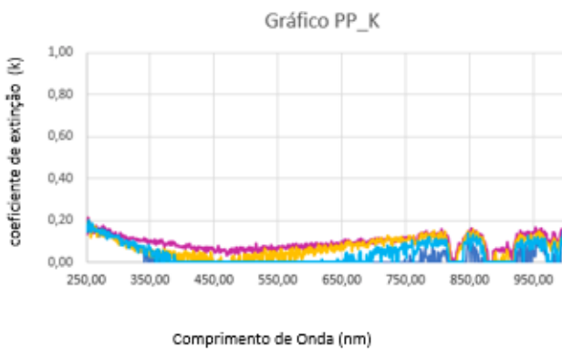
Figura 6. Gráfico do coeficiente de extinção para amostra de PP. P1, P2, P3 e P4 são pontos onde as medidas foram feitas.
