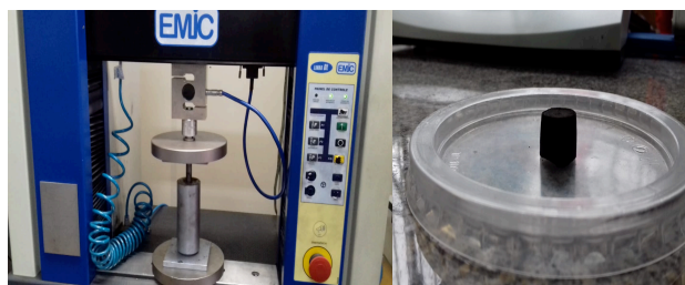
Figura 1 – Prensa hidráulica EMIC utilizada em ensaio de compressão para a confecção dos briquetes e briquete resultante do mesmo.
