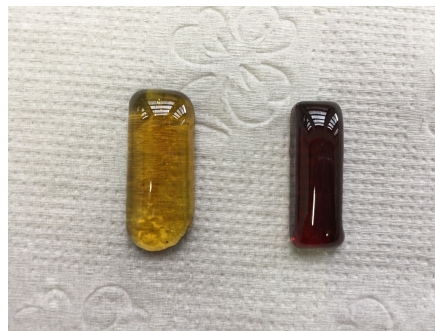
Figura 1. Vidro com a Escória de Distribuidor do Lingotamento e Vidro com a Escória de Aciaria.
