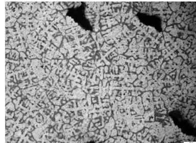
Figura 17: Microestrutura dendrítica na posição 85 mm da Liga Al-4%Cu em diferentes condições de superaquecimento. a) 25%, b) 15 e c) 5%.
