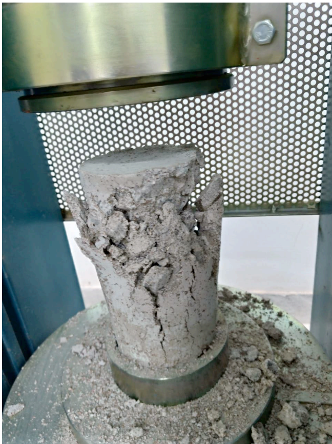
FIGURA 5. CONCRETO APÓS A COMPRESSÃO AXIAL
