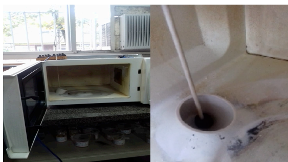
Figura 2 - Micro-ondas utilizado bem como a utilização do termopar para aquisição da variação de temperatura da amostra briquetada.
