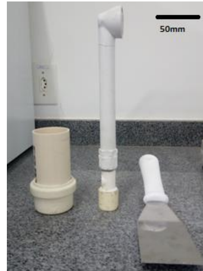
Fig.2: Aparato experimental utilizado na prensagem dos corpos de prova.
