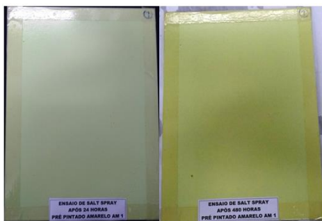
Fig. 3. Pré-pintado sem indícios de corrosão após 24 e 480 h de exposição à névoa salina, respectivamente.
