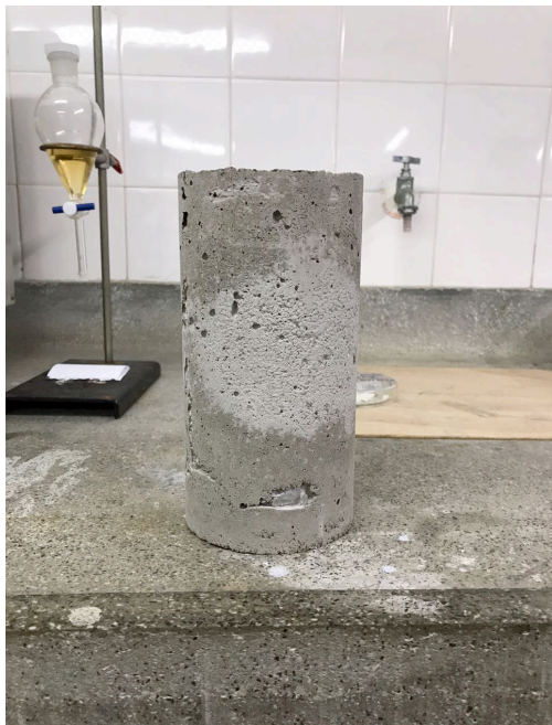
FIGURA 2. CONCRETO ANTES DA AÇÃO DO FOGO
