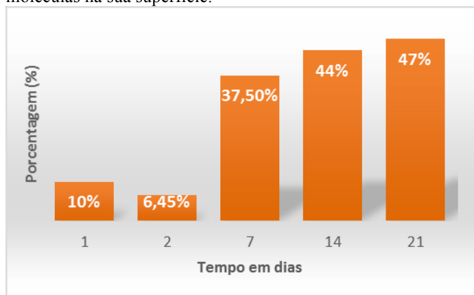
Figura6:Gráfico de colunas mostrando o índice de intumescimento (GI) para os ensaios de degradação de esferas de quitosana em solução simuladora de plasma (SBF)
