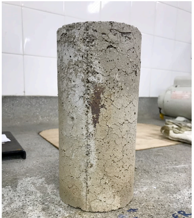
FIGURA 3. CONCRETO APÓS A AÇÃO DO FOGO
