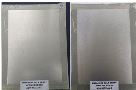
Fig. 4. Aço inoxidável duplex 2205 sem indícios de corrosão após 24 e 480 h de exposição à névoa salina, respectivamente.
