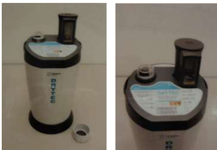
Figura 3.6: Gerador DRYTEC a realizar a eluição.
