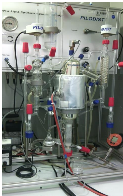
Figura 3.1 Aparelho de recirculação dinâmica VLE 100D da companhia Fischer utilizado neste trabalho.
