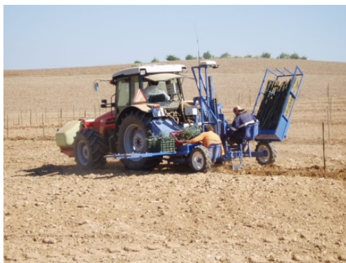
Figura 4.9 - Plantador mecânico guiado por satélite
