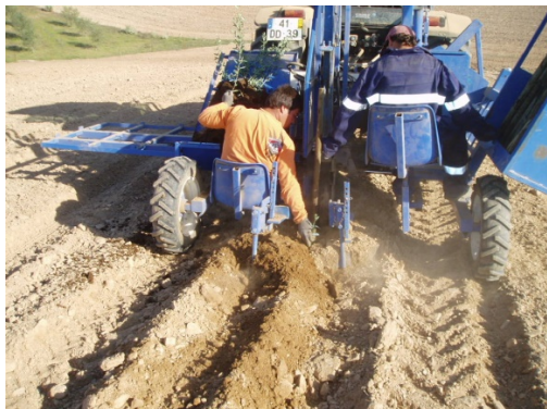
Figura 4.10 - Pormenor de funcionamento do plantador
