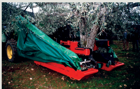
Figura 9 – Sistema II com o aparafritos fechado para deslocações entre árvores
