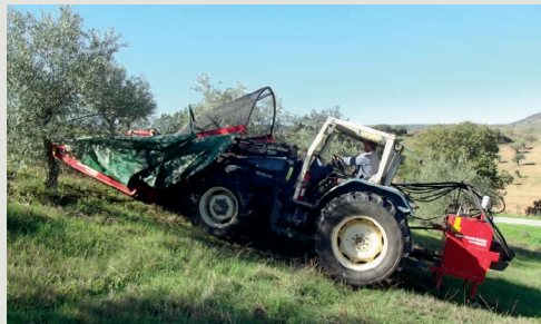
Figura 14 – Sistema II: equipamento movimentando-se perpendicularmente às curvas de nível em solo inclinado
