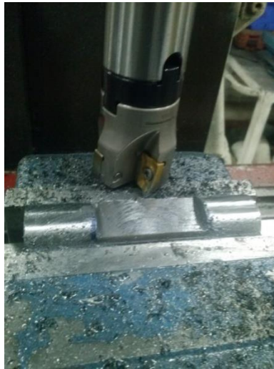
Figura 27 - Facejamento da peça utilizando uma fresa de 25mm de diâmetro.
