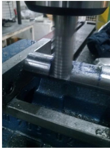
Figura 29 - Perfuração da peça, utilizando uma fresa com diâmetro de 10mm.
