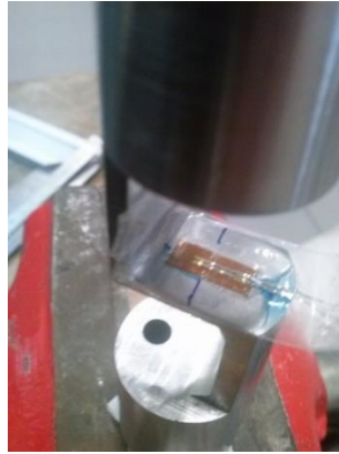
Figura 42 - Colocação dos extensómetros na zona de deformação.
