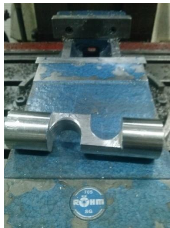
Figura 30 - Obtenção da forma em Z, utilizando uma fresa de 10mm de diâmetro.
