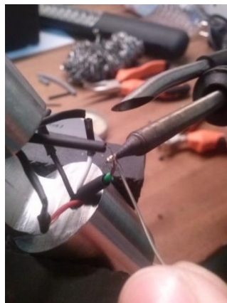
Figura 43 - Ligação dos fios por soldadura.
