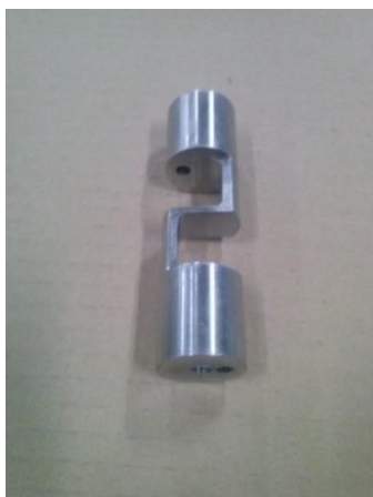
Figura 31 - Transdutor com o acabamento concluído.
