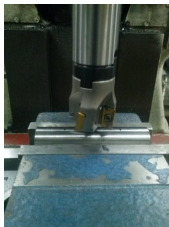
Figura 26 - Maquinagem da peça numa fresadora convencional.
