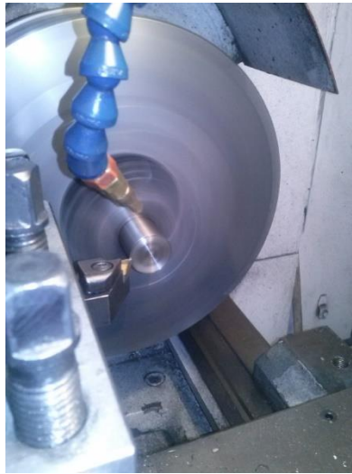
Figura 24 - Facejamento do veio para obter o comprimento do transdutor.
