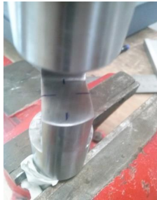
Figura 40 - Alinhamento dos extensómetros sobre a superfície de colagem.
