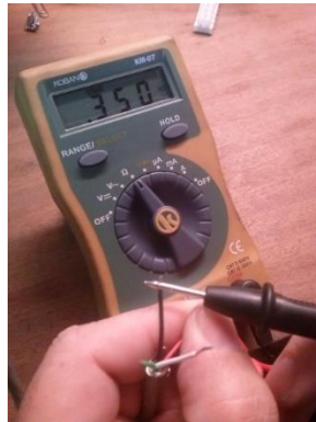
Figura 45 - Medição da resistência dos extensômetros após as ligações.
