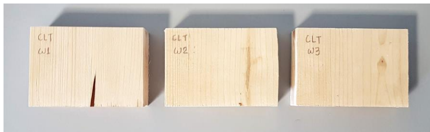
Figura 36 Amostras de CLT utilizadas para o teste de secagem.
