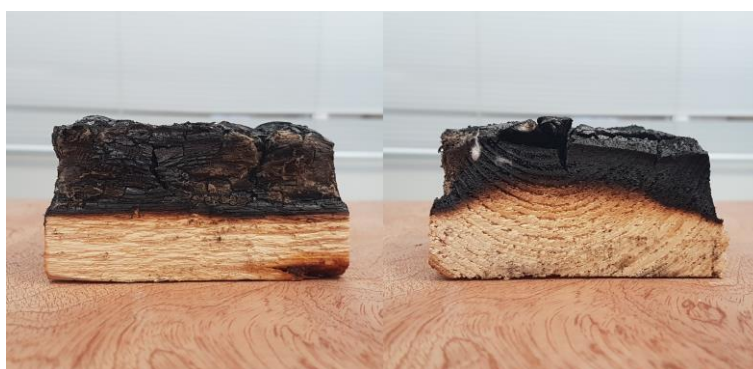
Figura 16 Efeito da carbonização em uma amostra exposta ao teste de Calorímetro de Cone.
