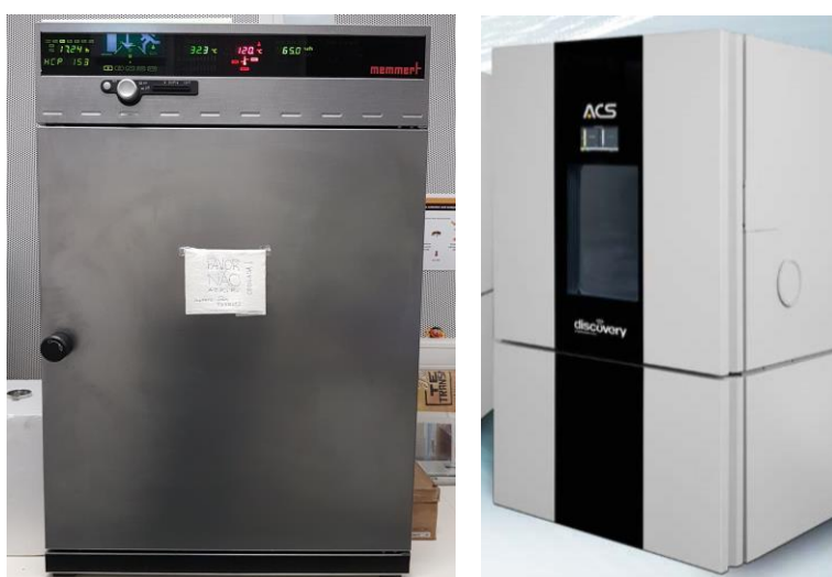
Figura 48 Câmara Climática, HCP 108 da Memmert, utilizada a esquerda. Câmara Climática, DM600 da Discovery, utilizada a direita.
