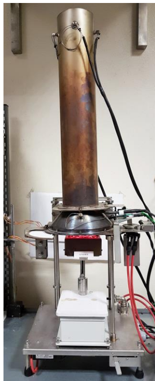
Figura 57 Equipamento Calorímetro de Cone utilizado nos ensaios.
