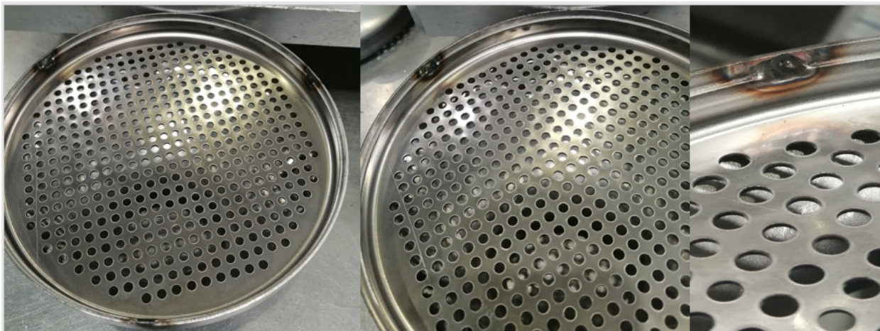
Figura 4.24: Resultado da soldadura em weave na linha
