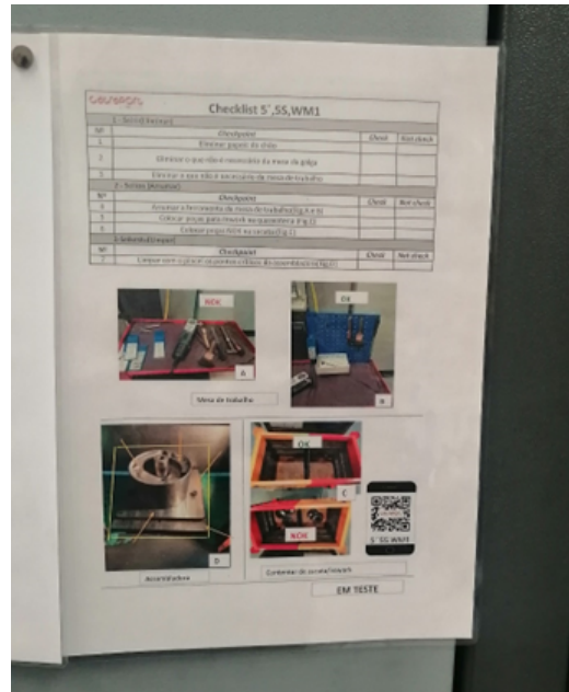
Figura 4.14: Checklist 5S, 5 minutos antes do fim do turno de produção com QR CODE
