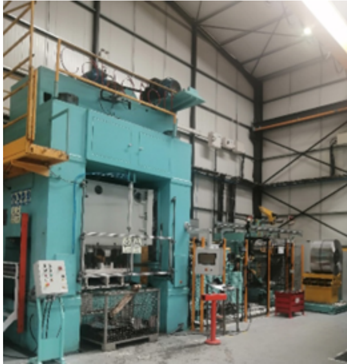
Figura 3.2: Exemplo de uma prensa de estampagem de metal
