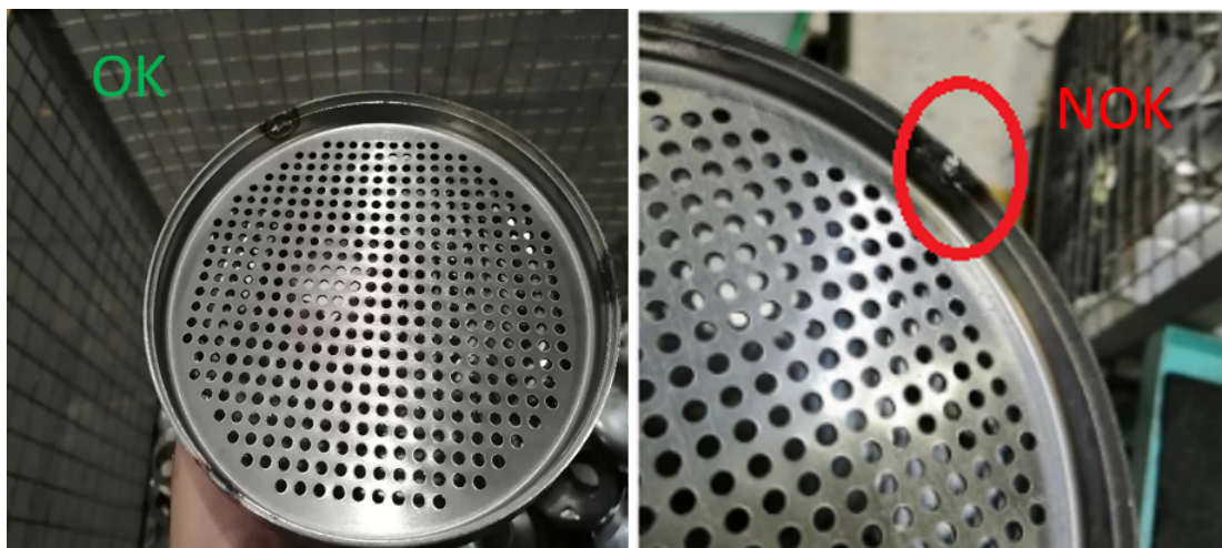
Figura 4.16: Peça conforme e peça sucata
