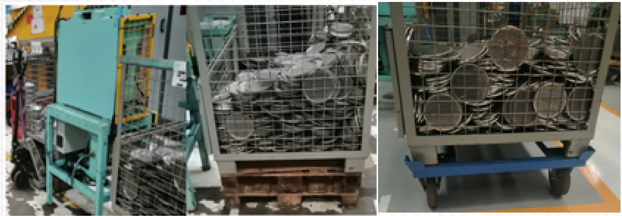
Figura 4.7: Substituição de paletes por uma estrutura móvel
