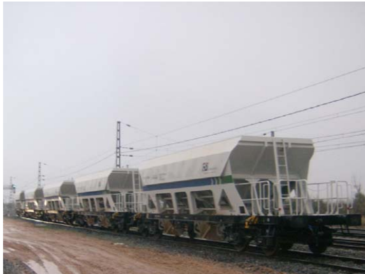
Foto 5. Tolvas de balasto
