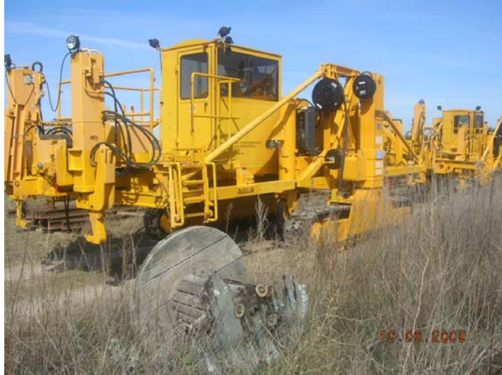
Foto 8. Pórticos para colocación de desvíos.
