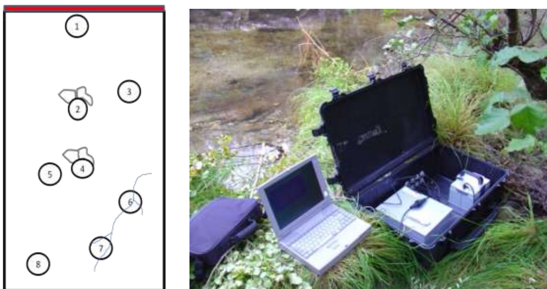
Figura 11. Disposição aleatória das antenas e Equipamento de PIT-Telemetria.
