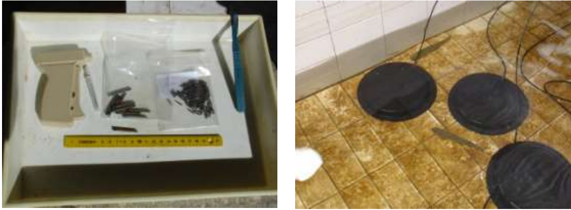
Figura 7. Equipamento de PIT-Telemetria (PIT-tags e antenas de detecção)
